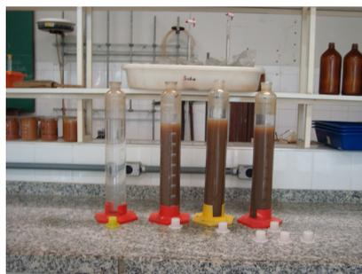
Figura 4 - Amostras em cilindros de sedimentação
