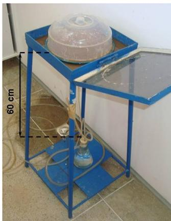
**Figura 8** - Mesa de tensão de sucção de 60 cm de coluna d'água
