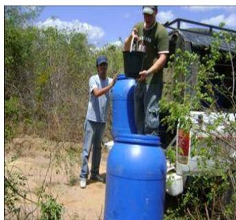
**Figura 5** - Tambores de 200 L com água utilizada nos testes de infiltração
