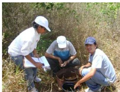
**Figura 6** - Teste de infiltração
