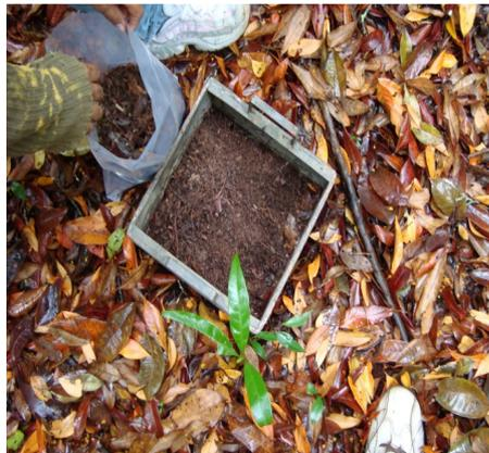
**Figura 9** - Amostrador de solos utilizado na coleta da macrofauna edáfica
