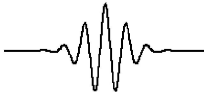
Figura 10 – Parte real da função Morlet para w_0 = 8 (Fonte: Torrence & Compo; A practical guide to wavelet analysis, 1998).
