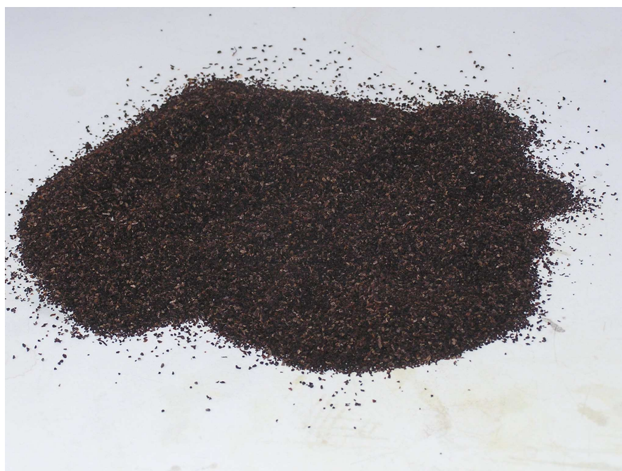
Figura 16 – Bagaço do pedúnculo de caju após tratamento com NaOH 0,1 mol/L e no tamanho de partícula 20 – 59 mesh.
