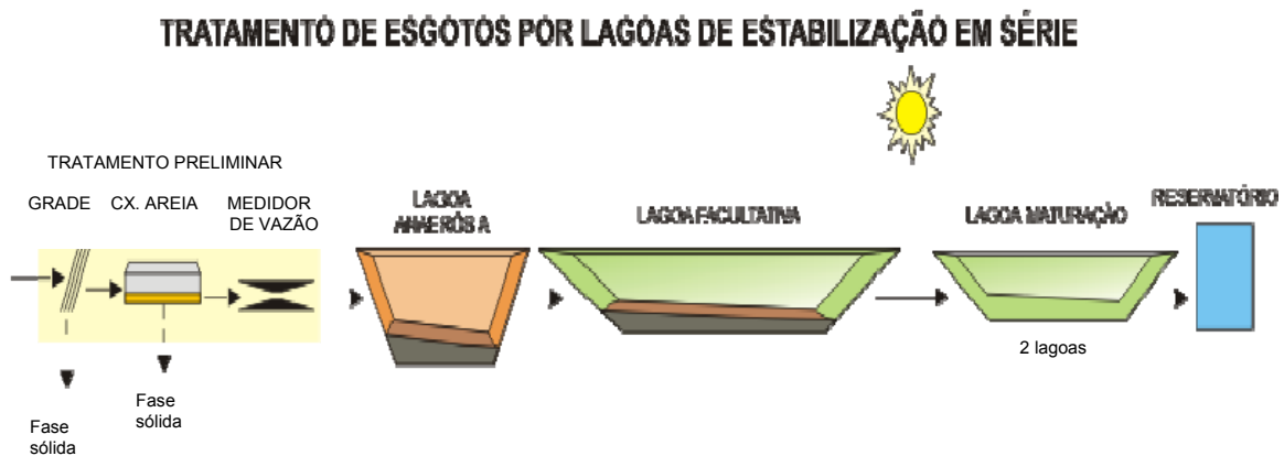
FIGURA 6 - Esquema do tratamento de esgotos sanitários do município de Aquiraz.
