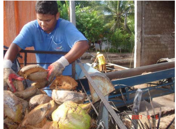
FIGURA 42 – Esteira que conduz as cascas de coco seco ao triturador
