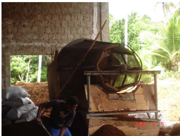
FIGURA 47 – Peneiramento do pó com fibrilas após secagem ao sol
