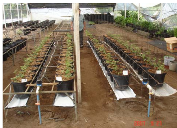
FIGURA 60 – Experimento montado com hidrômetros para controle do volume de água irrigado.
