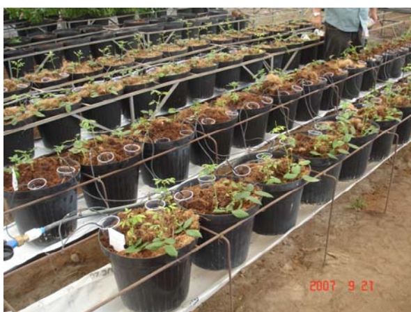
FIGURA 59 – Sistema de irrigação por gotejamento, com copos para coleta da vazão na realização do teste de uniformidade da vazão dos gotejadores
