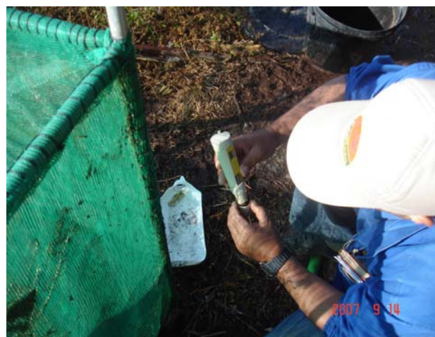
FIGURA 51 – Controle da CE do efluente da lavagem
