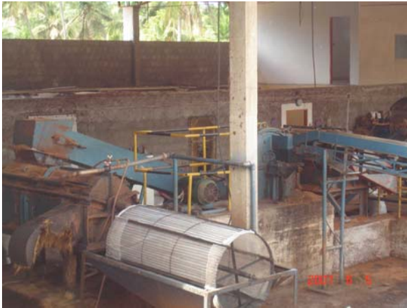
FIGURA 41 – Máquinas de processamento (trituração, peneiramento, lavagem)
