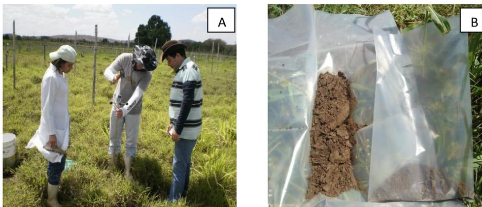
Figura 2- Procedimento para coleta de amostra de solo indeformada (A) e a amostra para análise de fertilidade do solo (B) na área experimental
