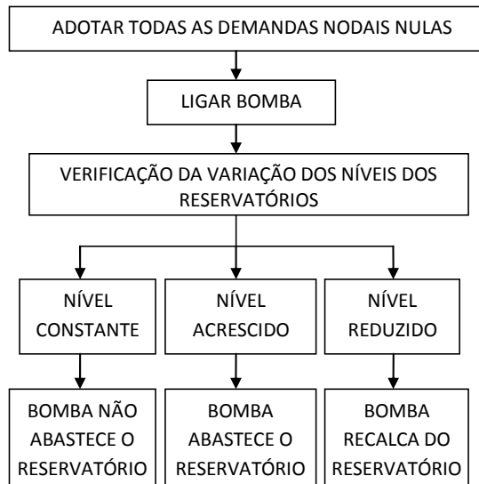
Figura 4.22: Determinação das bombas que influenciam cada reservatório
