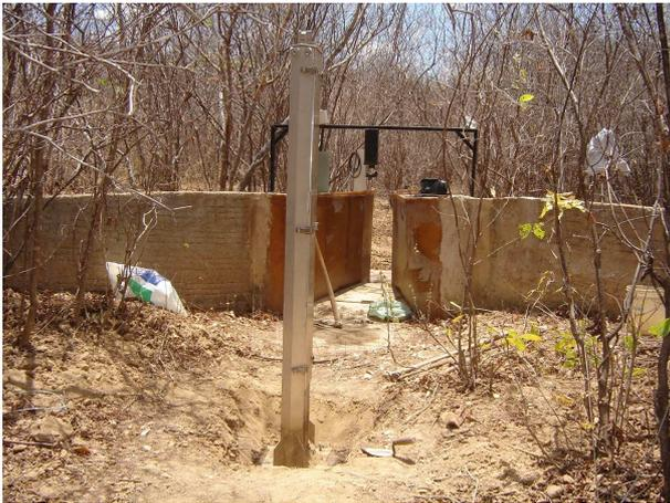
**Figura 16. Calha Parshall e amostrador de sedimentos no Riacho Boqueirão, Bacia Experimental de Aiuaba**
