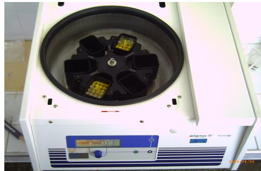
Figura 3.2 - Centrífuga refrigerada a 10°C modelo SIGMA 4K 15.
