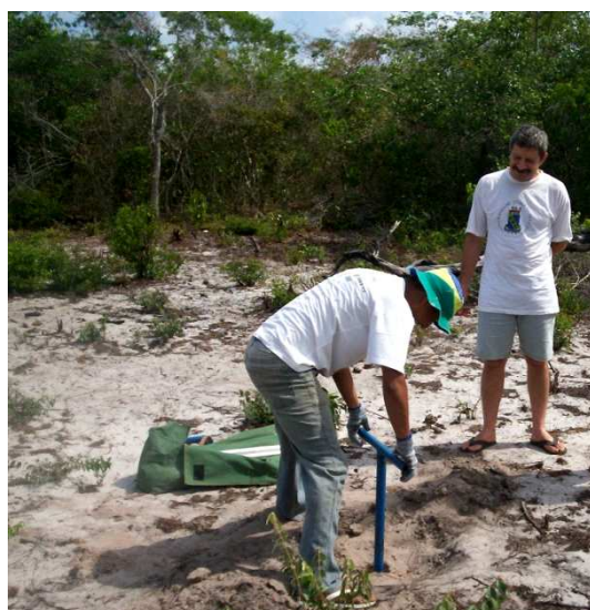
Figura 16 - Uso de trado manual na coleta de sedimentos.
