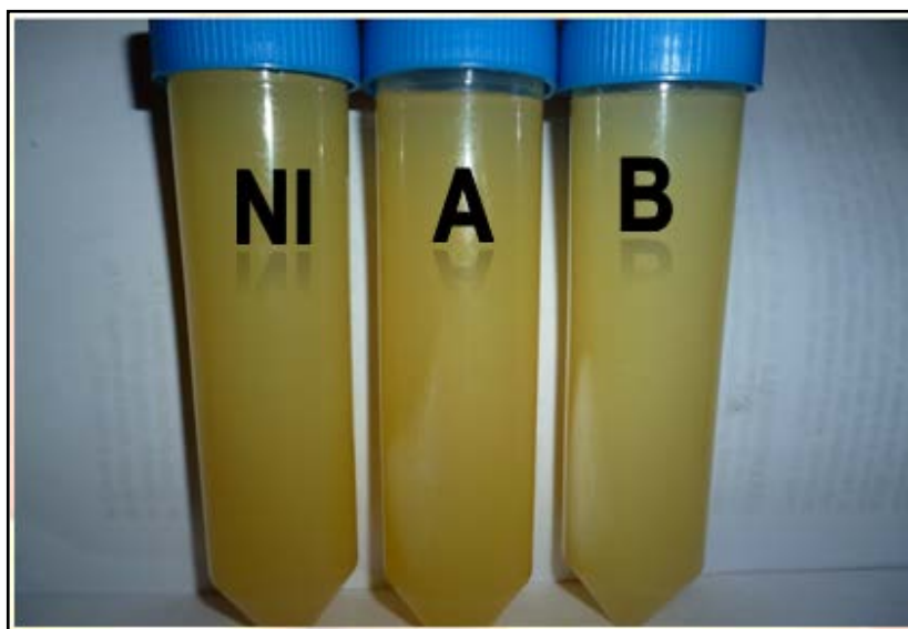
Figura 59. Teste de separação de fases no tempo 0 (NI = néctar de caju industrial; A = néctar de caju da marca A; B = néctar de caju da marca B).
