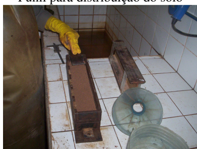
Regularização da altura da camada
