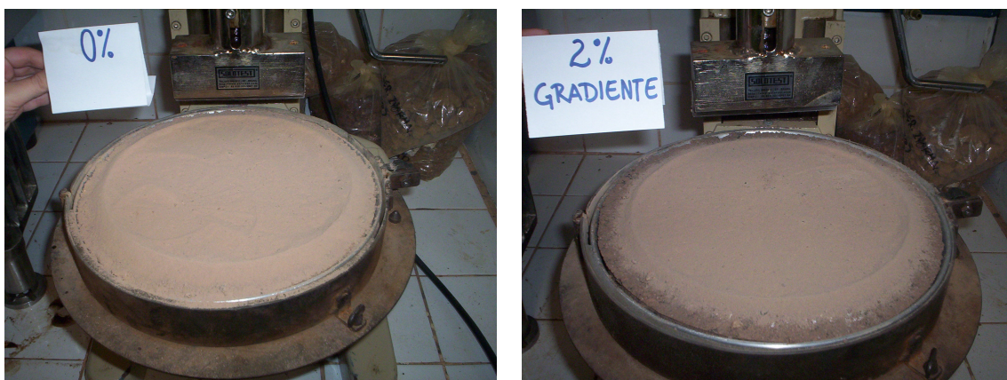
Figura 4.72 - Aspecto das amostras de solo B puro e estabilizado em gradiente, após o ensaio de WTAT.
