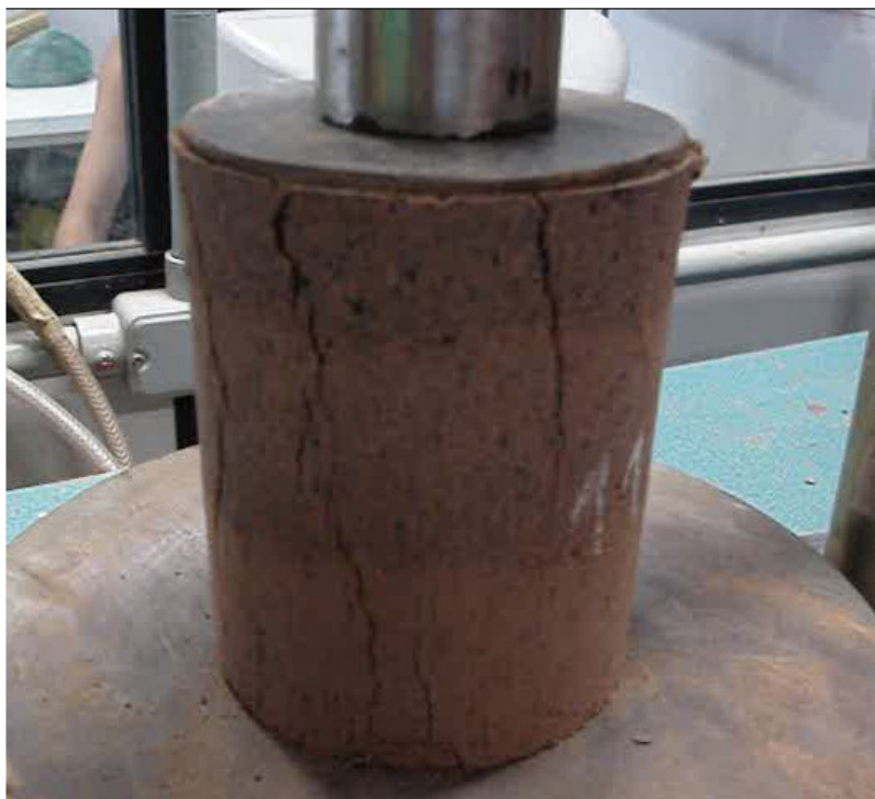
Figura 4.57 – Exemplo de padrão de ruptura das amostras em gradiente.
