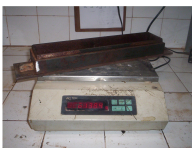
Pesagem da fôrma
