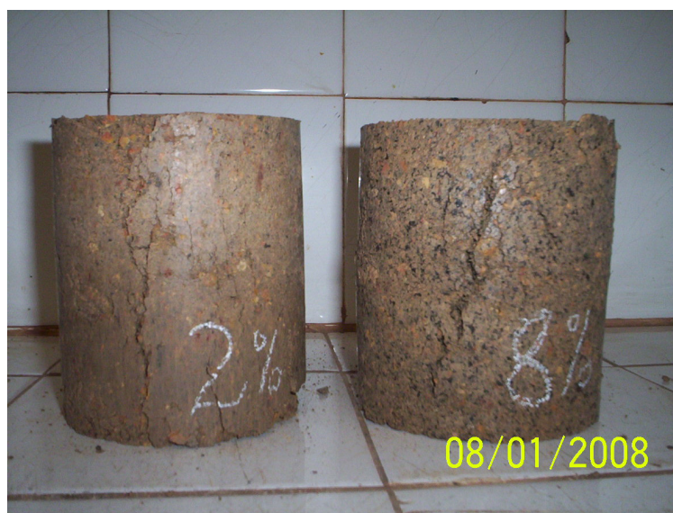
Figura 4.12 - Padrão de ruptura das amostras submetidas aos ensaios de resistência à compressão simples.
