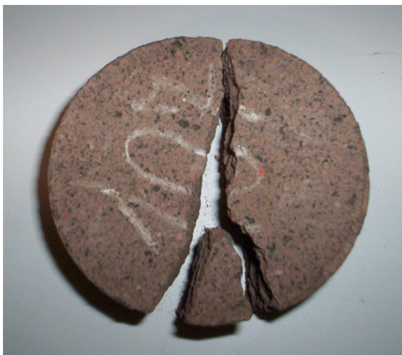
Figura 4.25 - Padrão de ruptura das misturas solo-emulsão submetidas aos ensaios de RTI.
