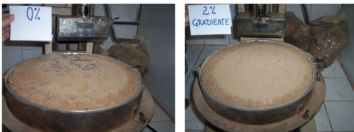
Figura 4.74 - Aspecto das amostras de solo C puro e estabilizado em gradiente, após o ensaio de WTAT.
