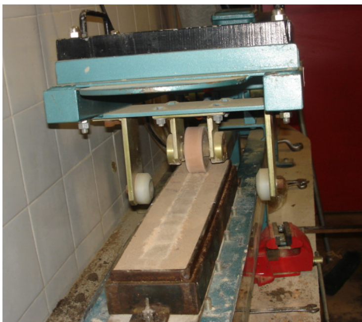
Figura 3.23 - Equipamento de LWT do LMP, durante execução do ensaio.
