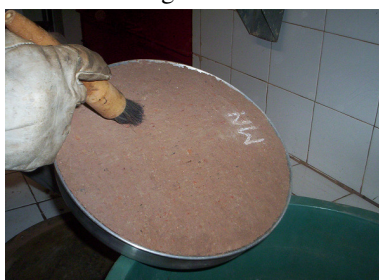
Retirada de excessos
