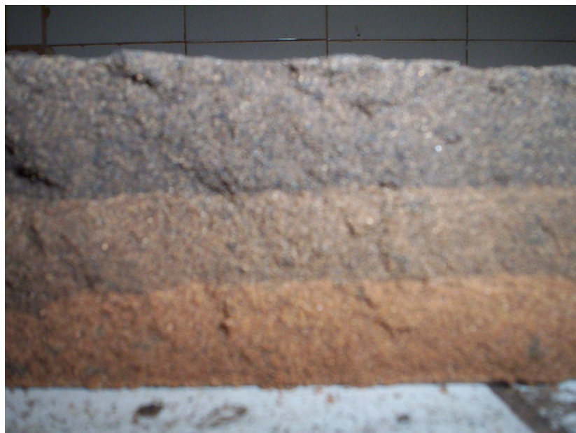
Figura 3.12 - Aspecto da distribuição da emulsão em gradiente em um corpo de prova.
