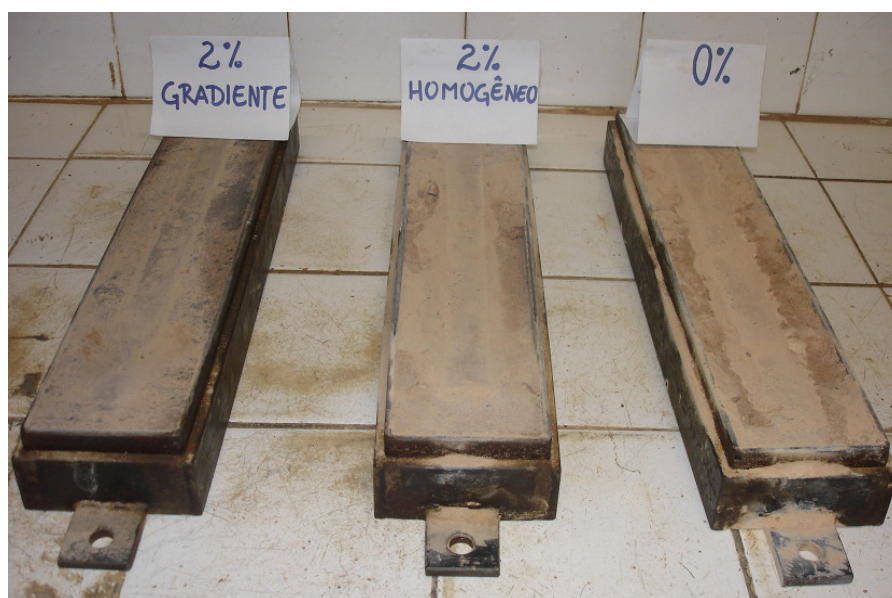
Figura 4.66 - Aspecto dos corpos de prova referentes ao solo B após a realização dos ensaios de LWT.
