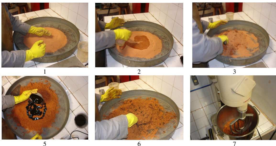
Figura 3.15 - Processo de mistura solo-emulsão.
