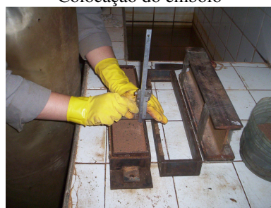
Verificação da altura da camada
