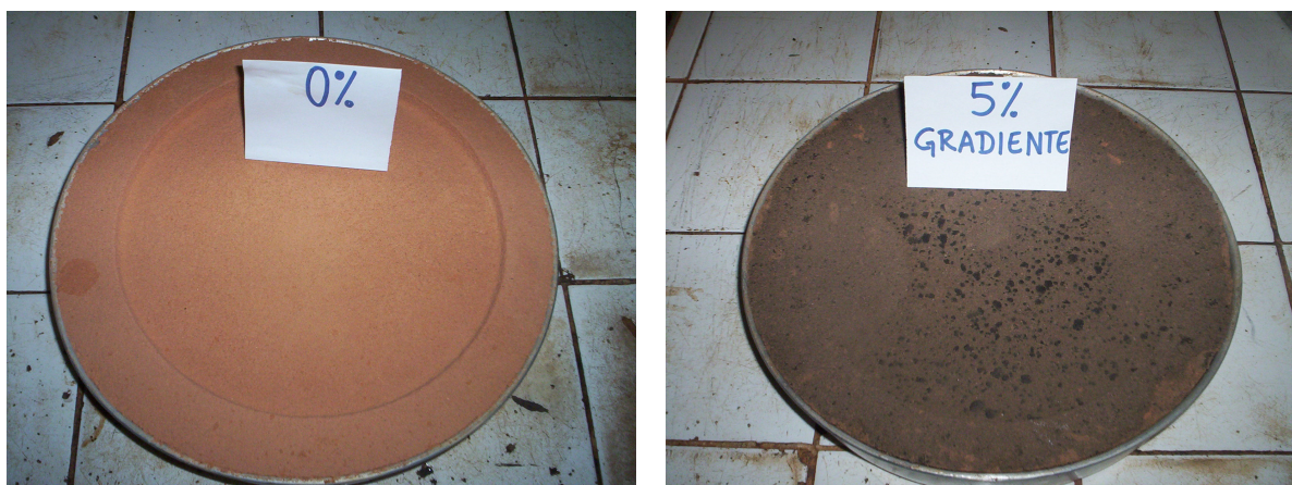
Figura 4.70 - Aspecto das amostras de solo A puro e estabilizado em gradiente, após o ensaio de WTAT.
