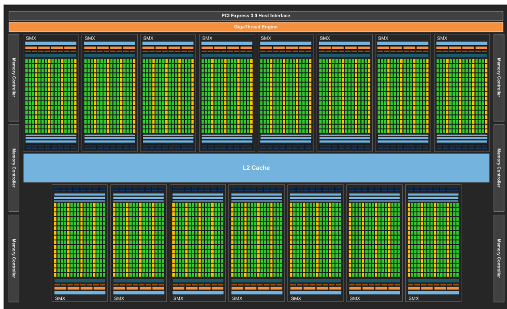
Figura 2.8: Diagrama de blocos arquitetura Kepler [KeplerGK110 2012]
