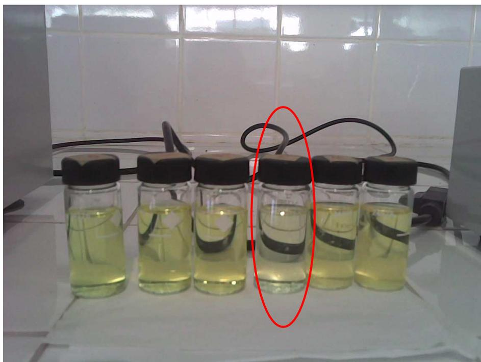
Figura 30 – Padrões da espectrofotometria, onde houve problemas no ponto de concentração  $100 \mu\text{g L}^{-1}$ . Esquerda para direita: “branco”,  $10 \mu\text{g L}^{-1}$ ,  $50 \mu\text{g L}^{-1}$ ,  $100 \mu\text{g L}^{-1}$ ,  $150 \mu\text{g L}^{-1}$ ,  $200 \mu\text{g L}^{-1}$ .
