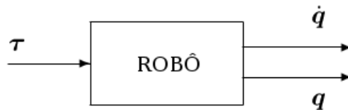
Figura 10 – Esquema de variáveis de entrada e saída de um manipulador industrial.
