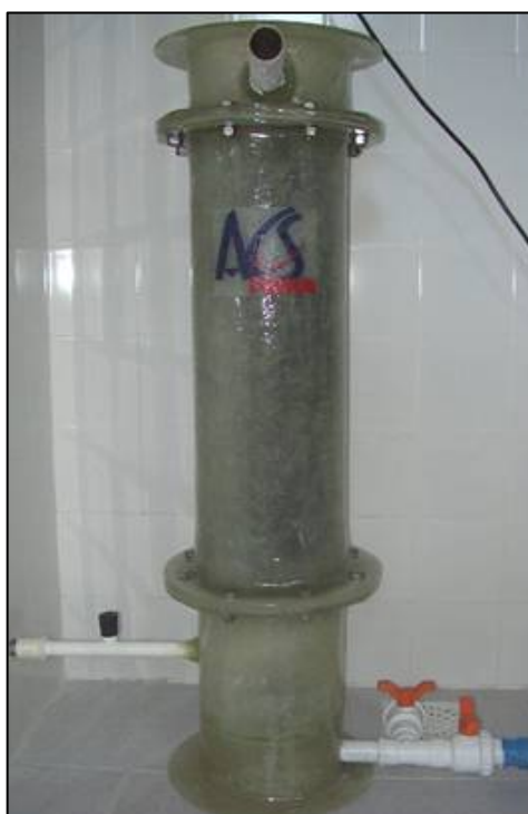
Figura 3.7: Reator Aerado Submerso.
