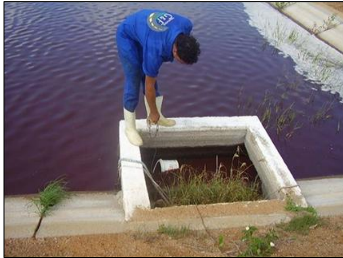
Figura 3.4: Coleta do lixiviado no vertedor da lagoa facultativa.
