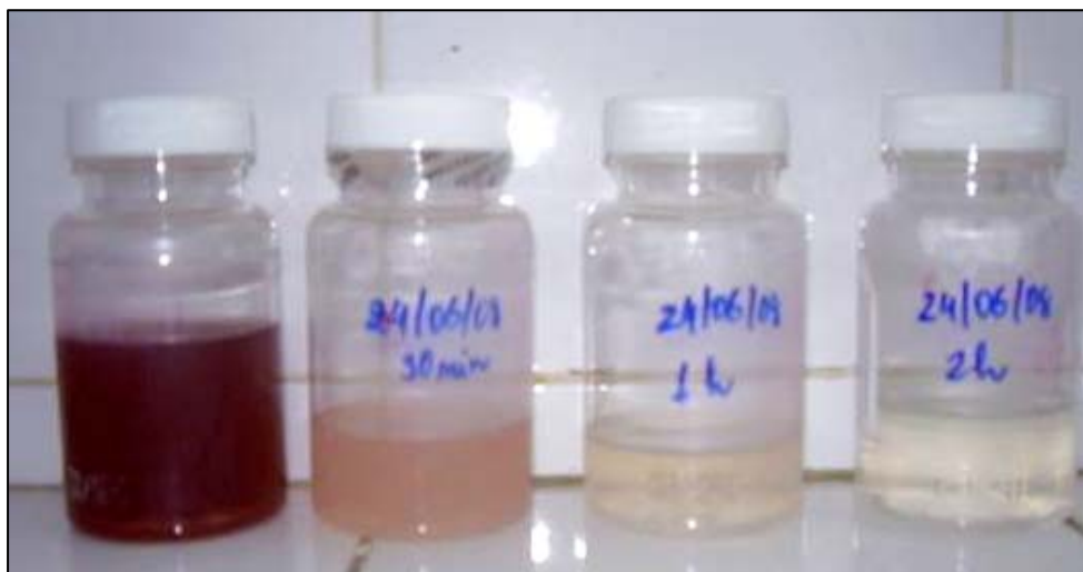
Figura 4.43: AM_4 bruta e alíquotas do lixiviado coletadas em 30, 60 e 120 minutos de reação.
