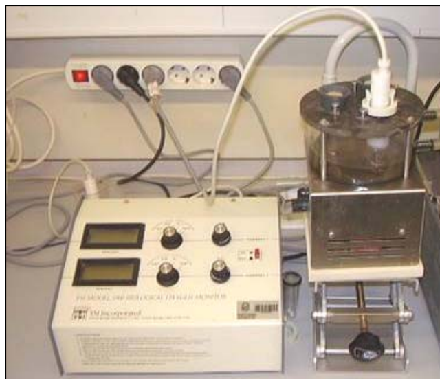
Figura 3.14: Equipamento do teste de respirometria.
