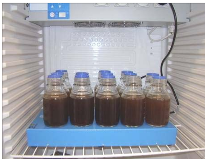
Figura 3.15: Câmara do teste de Zahn-Wellens.
