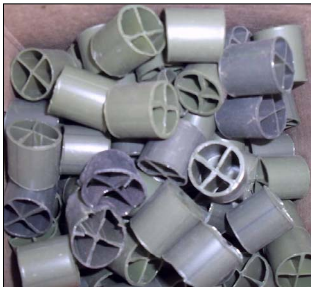
Figura 3.8: Material de preenchimento do meio suporte do RAS.
