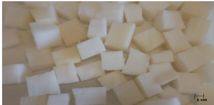
Figura 04. Esponja de poliuretano utilizada no método de réplica
