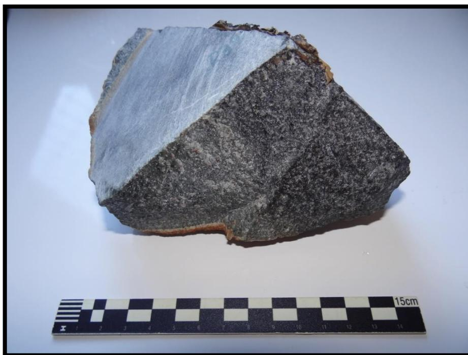
**Figura 20** - Calcissilicática com estrutura maciça e crosta de alteração na porção externa da amostra.
