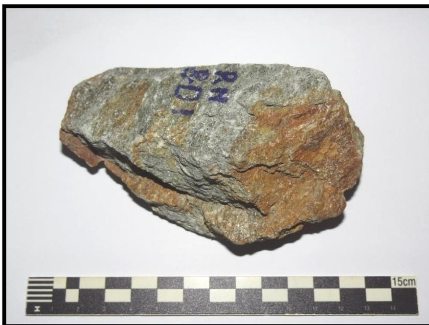
**Figura 22** - Anfibolito evidenciando a estrutura foliada devido à orientação prismática de pequenos cristais que parecem ser de anfibólio, apresentando coloração verde clara, com pequenas zonas de cor esbranquiçadas, provavelmente produto de alteração intempérica.
