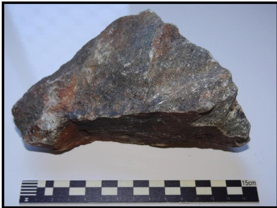
**Figura 4** - Anfibolito maciço, sem orientação marcada, com textura média, com coloração verde escura em sua porção não alterada e marrom em sua porção alterada.
