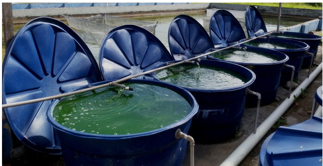
Figura 2 - Sistema de cultivo externo em recirculação da Arthrospira platensis .
