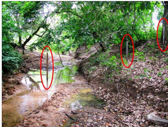
Figura 23 – Estação fluviométrica EF1 na microbacia hidrográfica do São José
