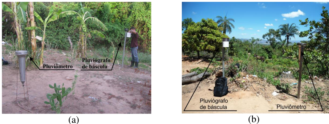
Figura 26 – Estações pluviométricas instaladas na microbacia hidrográfica do São José
