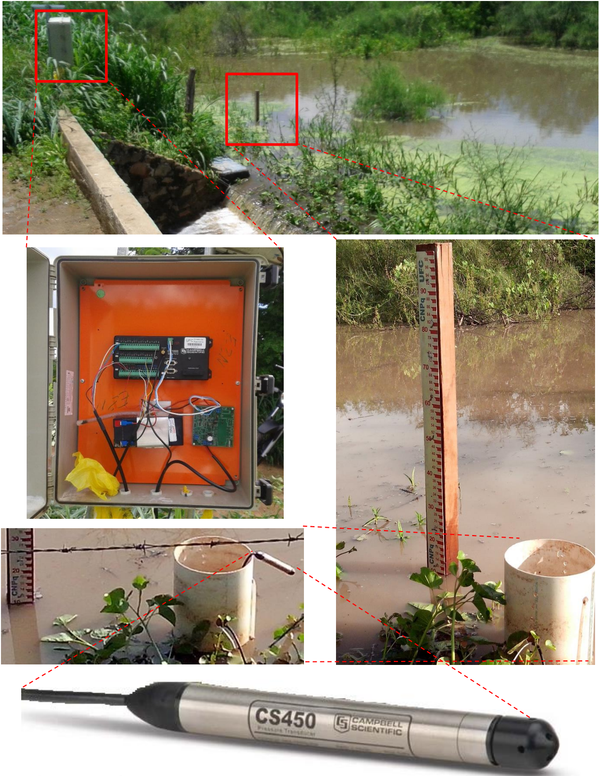
Figura 28 – Sensor de nível, datalogger e Régua linimétrica na Seção de monitoramento da Bacia Experimental de Iguatu (BEI)
