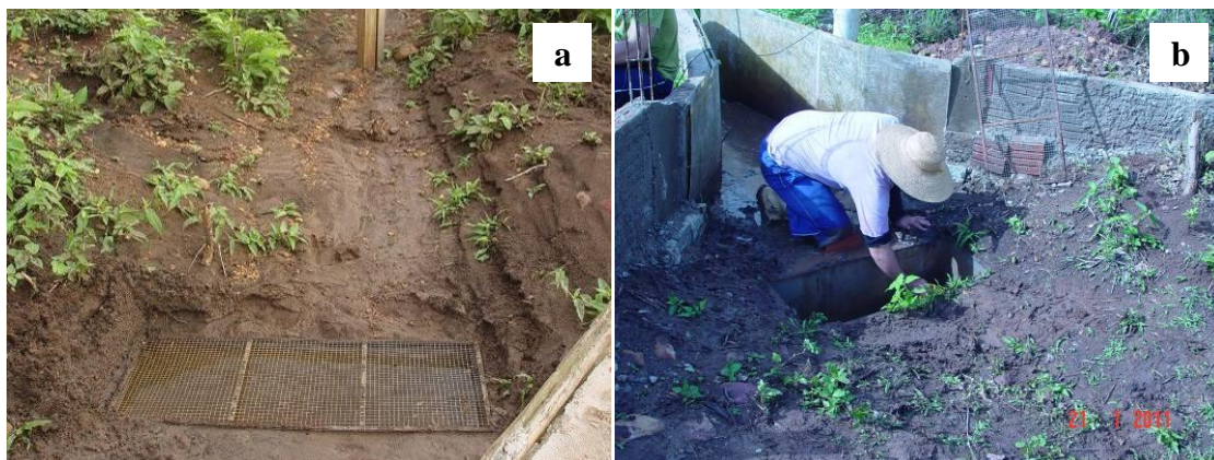
Figura 18 – Fosso coletor de sedimentos em arraste de leito (a) e em detalhe o processo de coleta de amostras de água e sedimentos (b)
