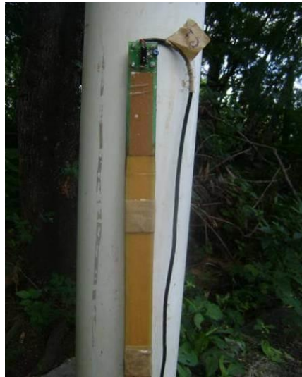
Figura 16 – Sensor de nível (linígrafo) usado para medir a altura da água na calha
