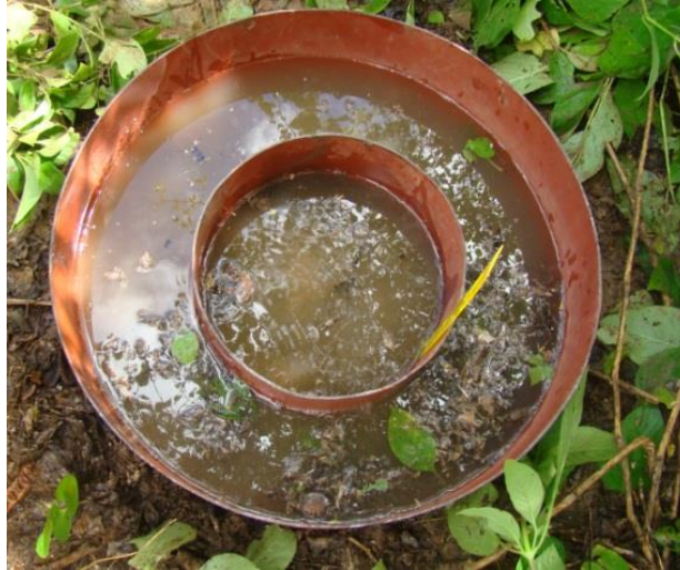
Figura 20 – Anéis instalados em campo para determinação da curva de infiltração pelo método do infiltrômetro de anel com carga variável
