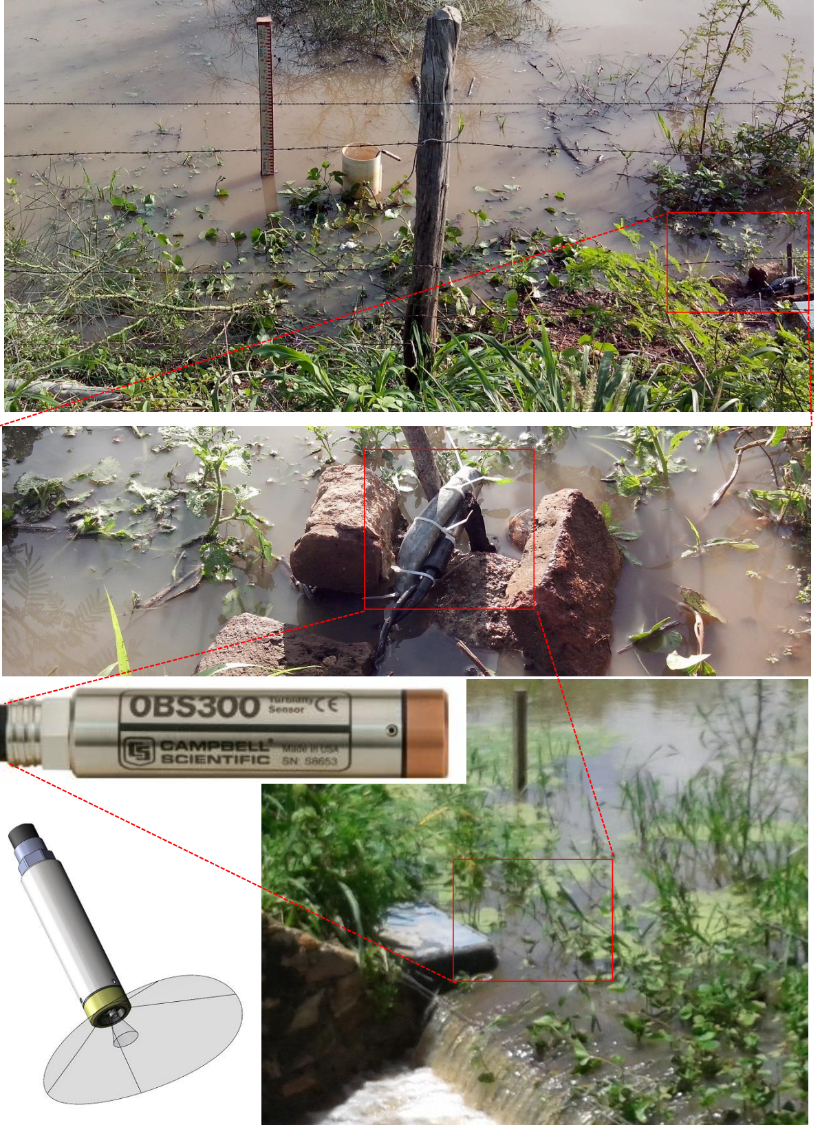
Figura 29 – Turbidímetro OBS300 instalado na seção de monitoramento da Bacia Experimental de Iguatu (BEI)
