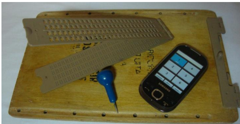
Figura 32 - Ferramentas tradicionais de escrita em Braille e uma tela do serviço LêBraille.
