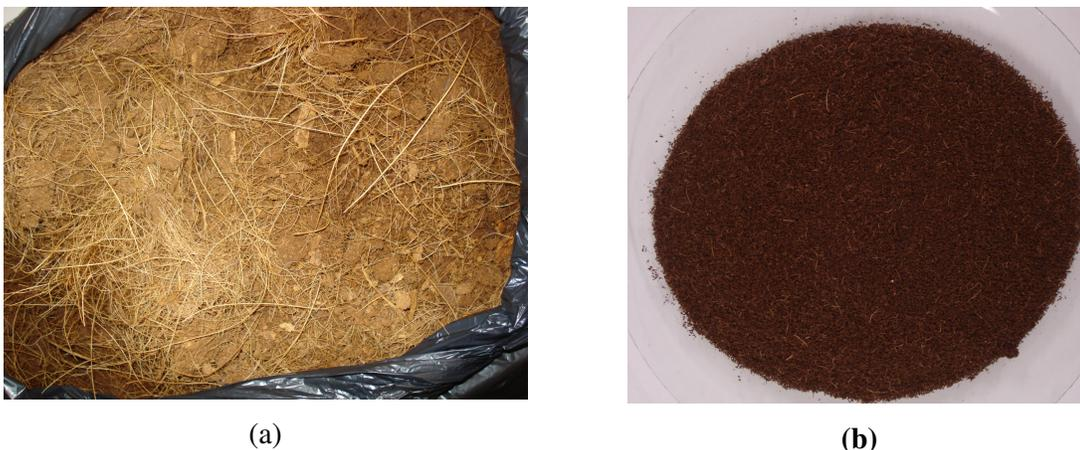
**Figura 5** – Pó do bagaço bruto da casca de coco *in natura* sem tratamento superficial (a) e pó do bagaço da casca de coco *in natura* obtido após lavagem, secagem e separação das fibras (b).
