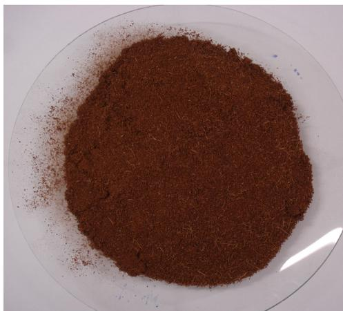
**Figura 6** - Pó do bagaço da casca de coco após tratamento com HCl 1,0 M (BT).
