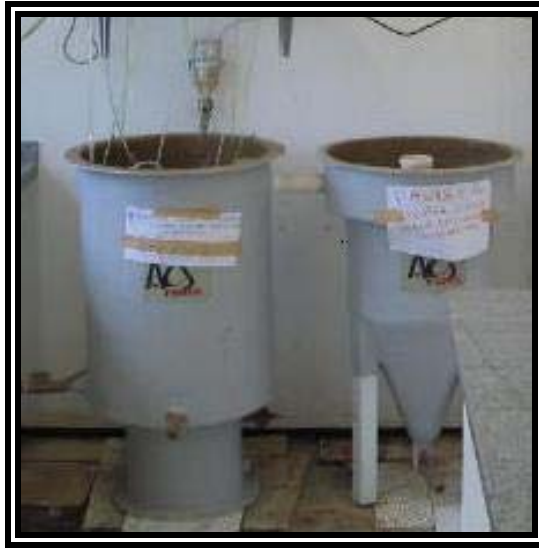
FIGURA 12 – Sistema RBF-decantador utilizado na pesquisa.
