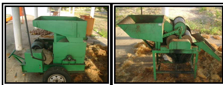
FIGURA 4 – Máquina de trituração (à esquerda) e prensagem (à direita) da casca do coco verde onde era produzido o LCCV.
