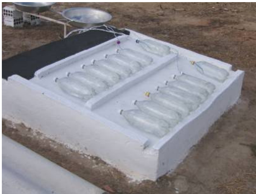
Figura 14 - Garrafas agitadas e não agitadas expostas à radiação solar. Fortaleza, Ceará. 2005
