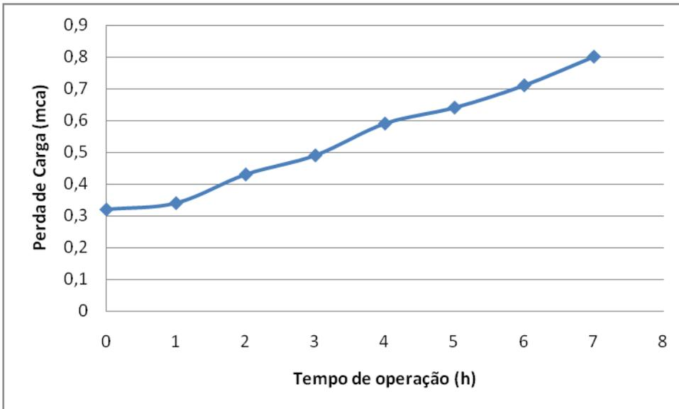
Figura 5.10 – Variação da perda de carga durante a carreira de filtração 2, água sintética com 7,5 mg/L de ferro.
