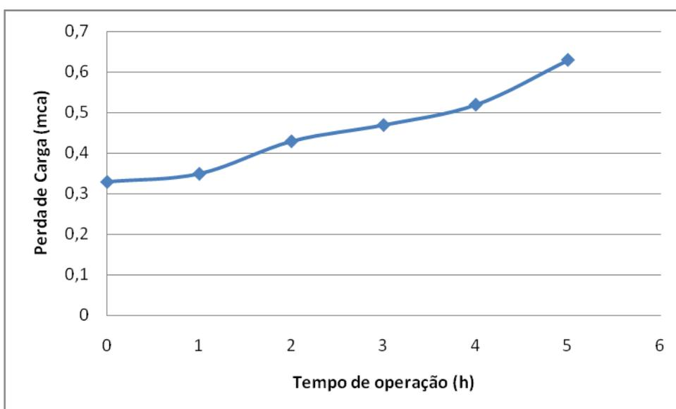
Figura 5.6 – Variação da perda de carga durante a carreira de filtração 1 com água sintética com 10 mg/L de ferro.
