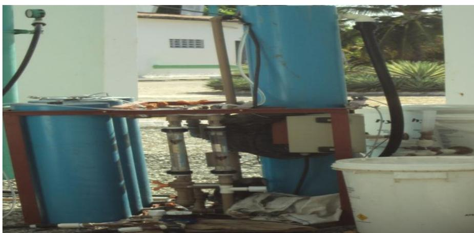
Figura 3.4 – Hidrômetro e Rotâmetros utilizados como medidores de vazão
