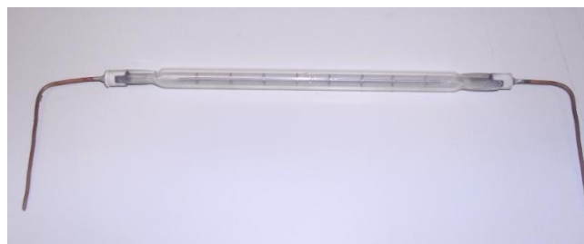
Figura 3.5 - Foto da lâmpada halógena com solda prata nos terminais.
