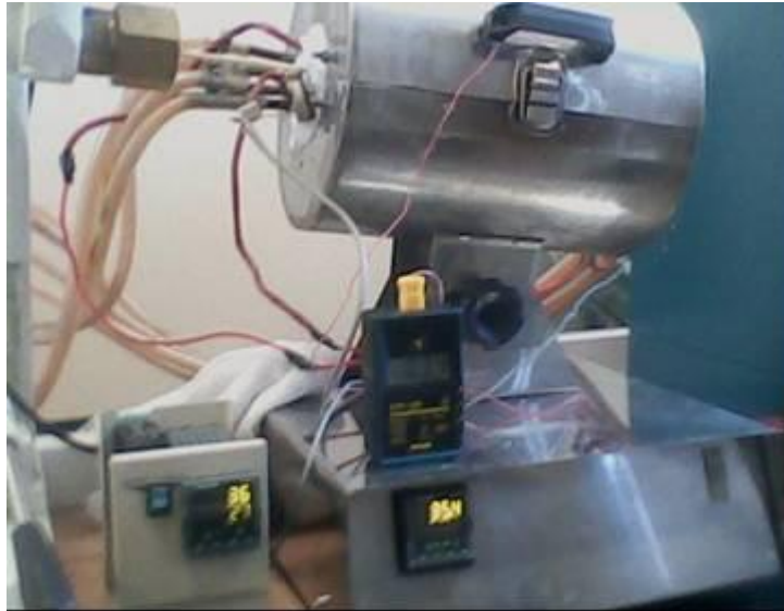
Figura 4.9 - Forno com termopares acoplados para obtenção das medidas: carcaça metálica, placa refletora e centro no interior do forno.
