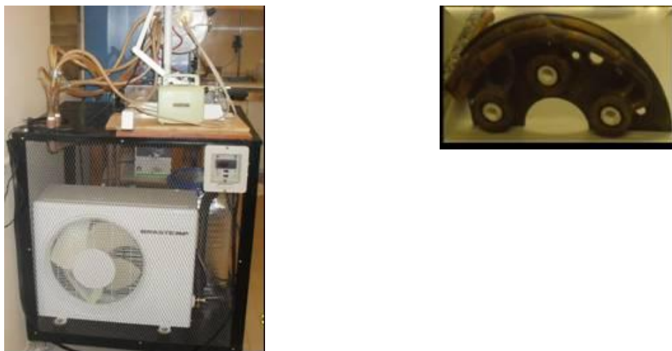
Figura 3.13 - Sistema de refrigeração do forno tubular (direita) e trocador de calor que encapsula os contatos das lâmpadas halógenas (esquerda)
