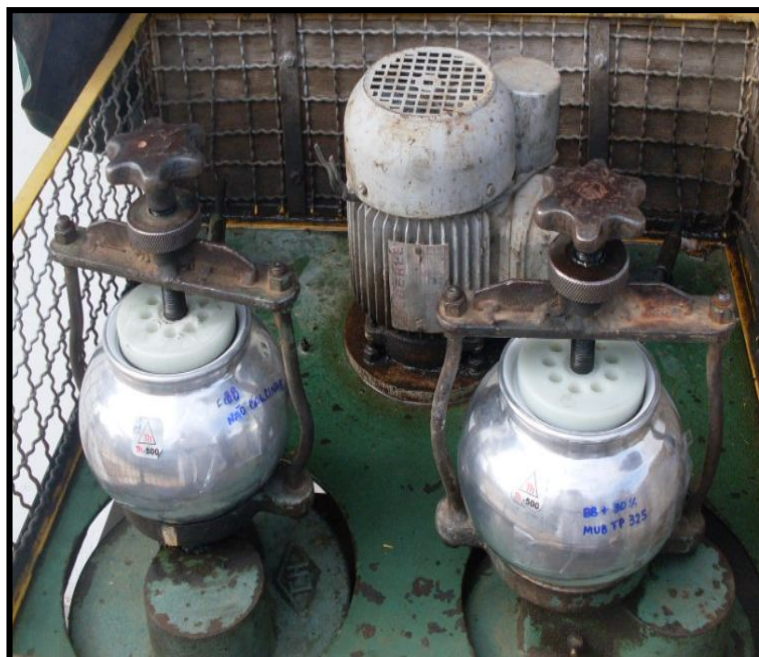
Figura 3.7 - Moinho médio rotatório (modelo Thermoceram - Indústria de Artefatos Cerâmicos – Mogi Guaçu - SP).
