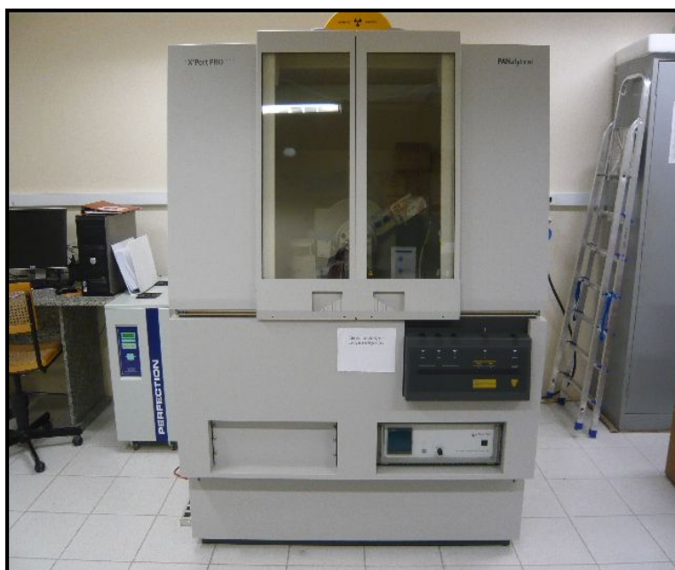
Figura 3.5 - Difratômetro de raios x da marca Panalytical modelo X'Pert Pro MPD. Fonte: www.fisica.ufc.br
