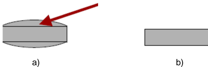
Figura 2.12 - a) Gases retidos na amostra após sinterização; b) Peça corretamente sinterizada. Fonte: falves@fe.up.pt , www.fe.up.pt/~falves .
