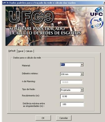
Na aba inicial do Default o usuário pode modificar itens como material dos tubos (a tela de Default mostra o coeficiente de Manning do material), diâmetro mínimo dos tubos, tipo de rede (projetada ou existente), recobrimento mínimo e distância máxima entre as singularidades.
