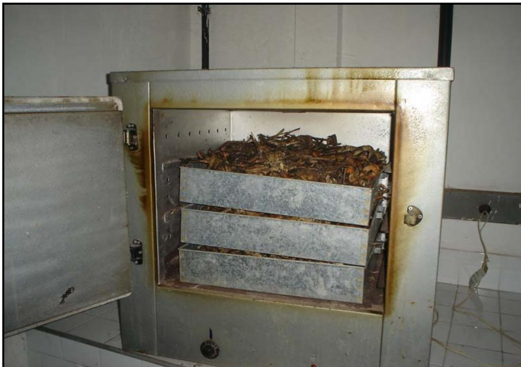
FIGURA 3.8 – Secagem do material coletado em estufa a 80°C por 12 horas.
