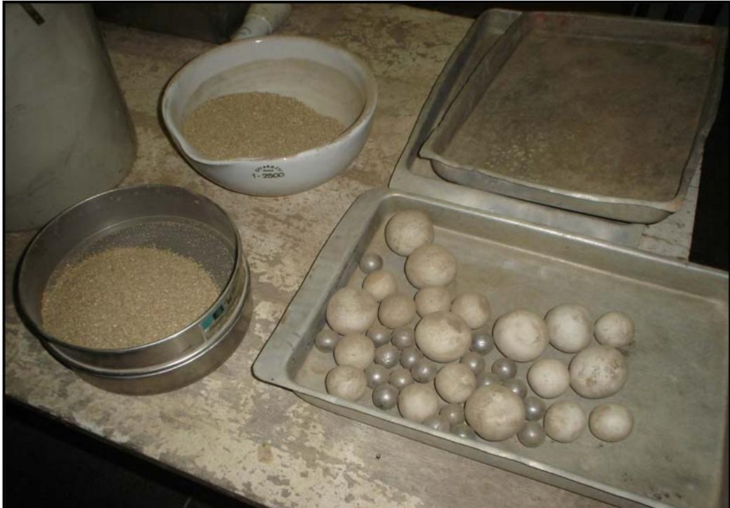
Figura 3.10 – Peneira, esferas de cerâmica e aço utilizados na produção da farinha de caranguejo.
