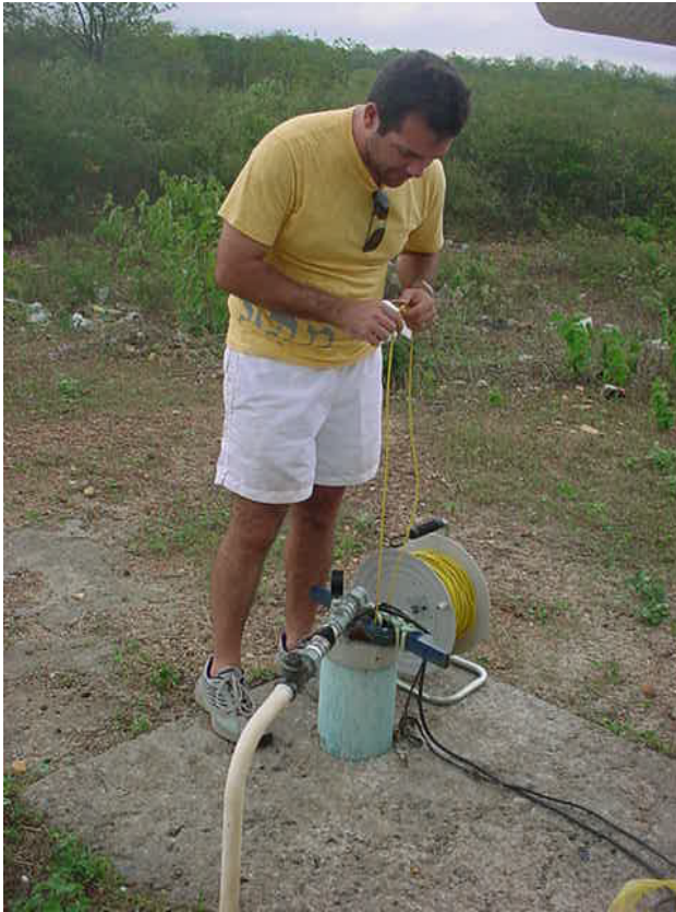
FIGURA 24 – Medida do NE no poço 5a localizado no Posto Fiscal (Tianguá, 2004).
