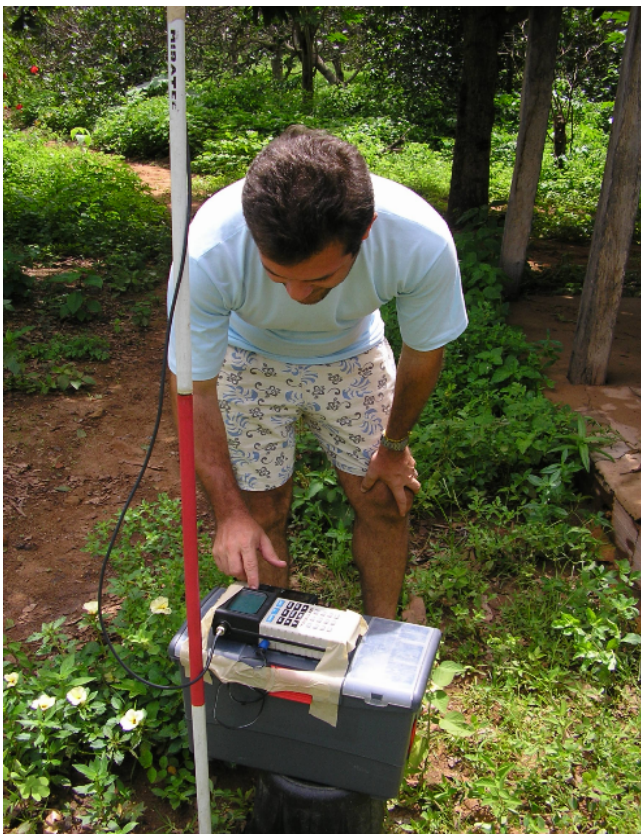
FIGURA 25 – Levantamento planialtimétrico a partir de receptores GPS no poço 8a (Tianguá, 2003).
