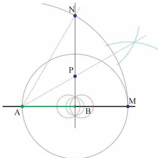
**Figura 2.16:** Construção do heptágono. Identificando o ponto P.
