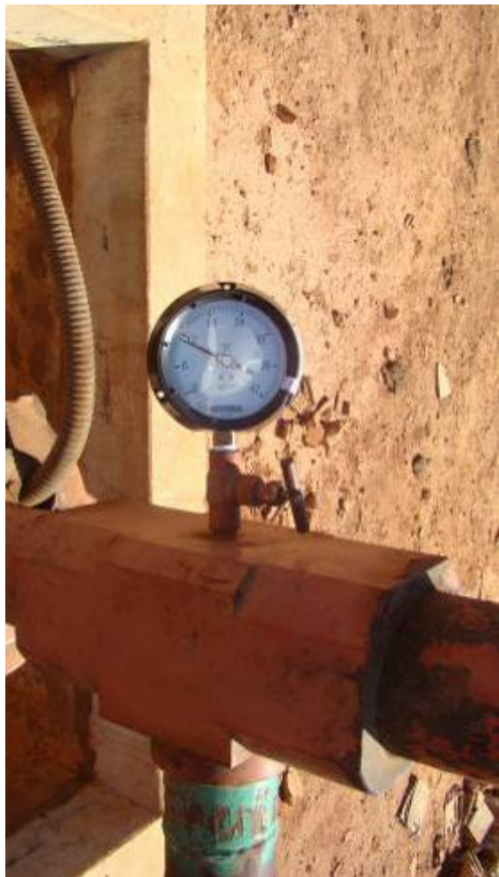
Figura 5.27. Medidor de pressão em três momentos: 1) com a bomba desligada (pressão nula); 2) durante o enchimento da adutora (pressão 8 kgf/cm 2 ) e 3) durante o enchimento do reservatório, quando a pressão se estabilizou em 11 kgf/cm 2
