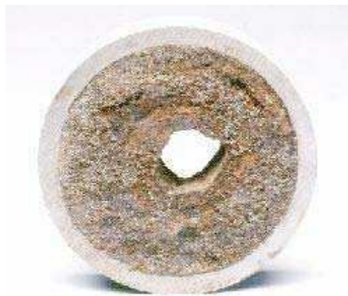
c) Deposição de parafina no interior do duto.
