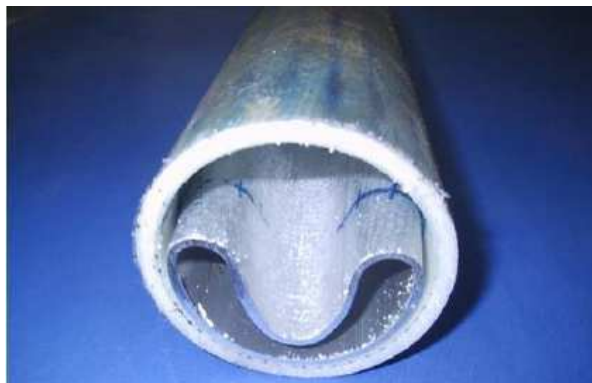
Figura 3.3 – Colapso do liner metálico devido à ausência de liner externo (OLIVEIRA, 2006).
