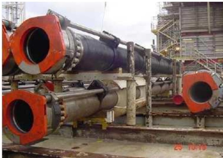
Figura 3.4 – Juntas de riser de perfuração em compósito (SALAMA et al. , 2002).
