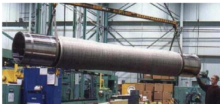
Figura 1.3 – Junta de teste do riser compósito de Heidrun (SALAMA et al. , 2002).
