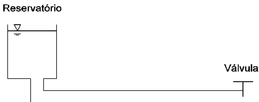
FIGURA 4.1 – Sistema composto por reservatório, tubulação e válvula à jusante.
