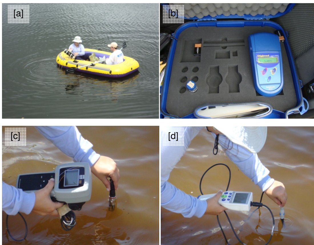
FIGURA 6 - Equipamentos e sondas utilizadas para análise da água [a] Garrafa de Van Dorn [b] Turbidímetro [c] oxímetro [d] Condutivímetro. Madalena-Ce, 2010.
