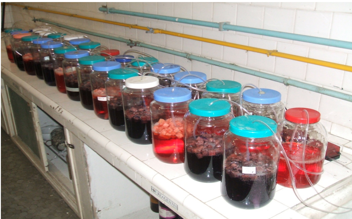
Figura 4.3: Reatores CD, CI, FD, FI, FDG e FIG operados em batelada para remoção de vermelho do congo em meio aquoso sintético.
