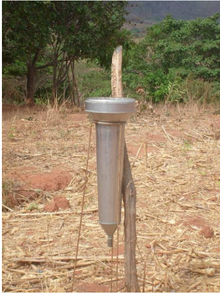
Figura 4.5 – Pluviômetros instalados nas Bacias de Pai João e Santo Antônio
