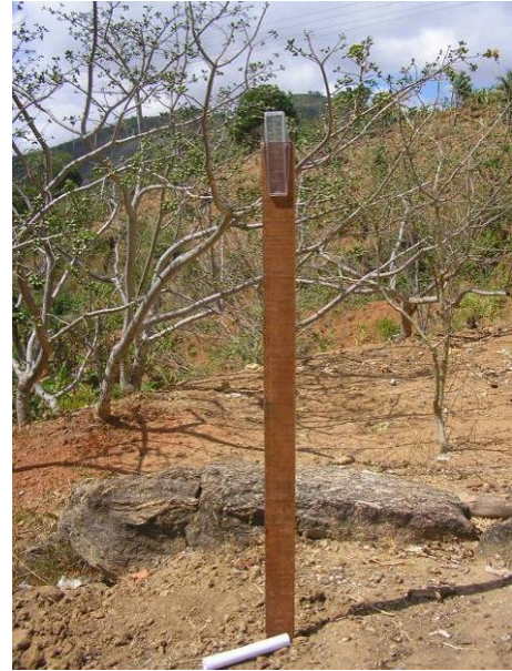
Figura 4.5 – Pluviômetros instalados nas Bacias de Pai João e Santo Antônio
