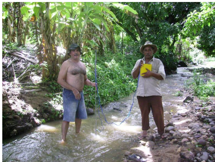
Figura 4.6 – Medição de vazão utilizando micro-molinete
