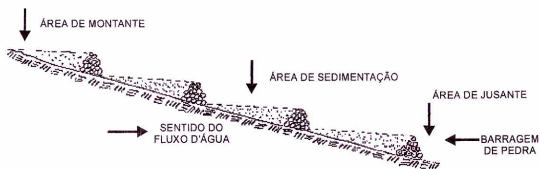
Figura 3.13- Esquema do sequenciamento de barragens de contenção de sedimentos. Fonte: Ceará (2001).
