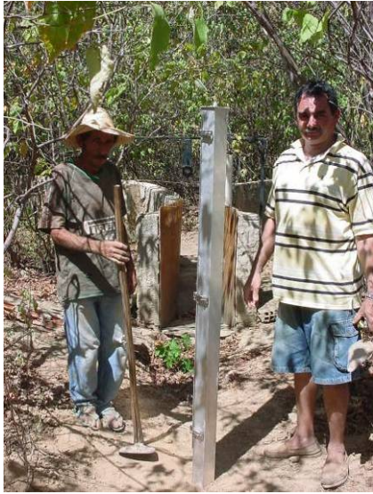
(a) Amostrador automático de sedimentos para o ramo ascendente do hidrograma.
