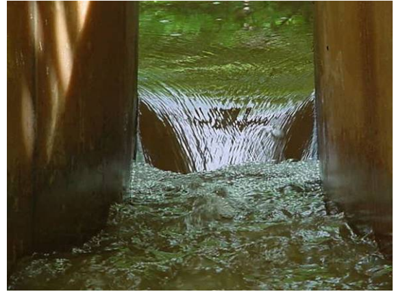
(e) escoamento no riacho principal da bacia, detalhe da Calha Parshall
