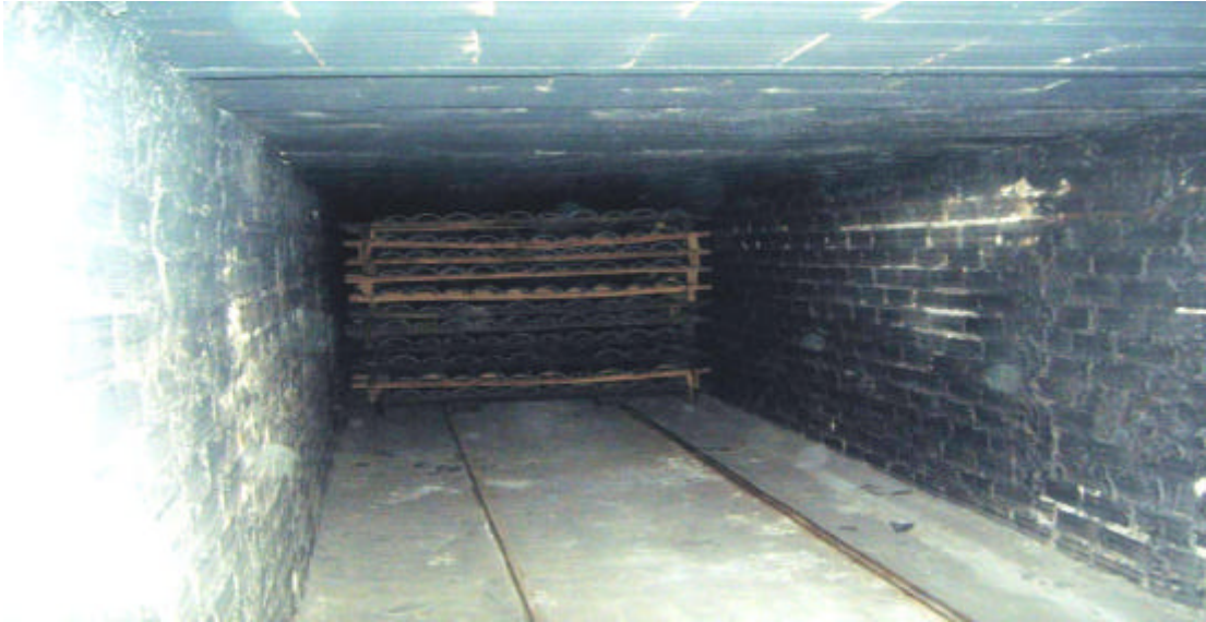
Foto 20. Peças cerâmicas em vagonete no interior de um secador artificial do tipo túnel.
