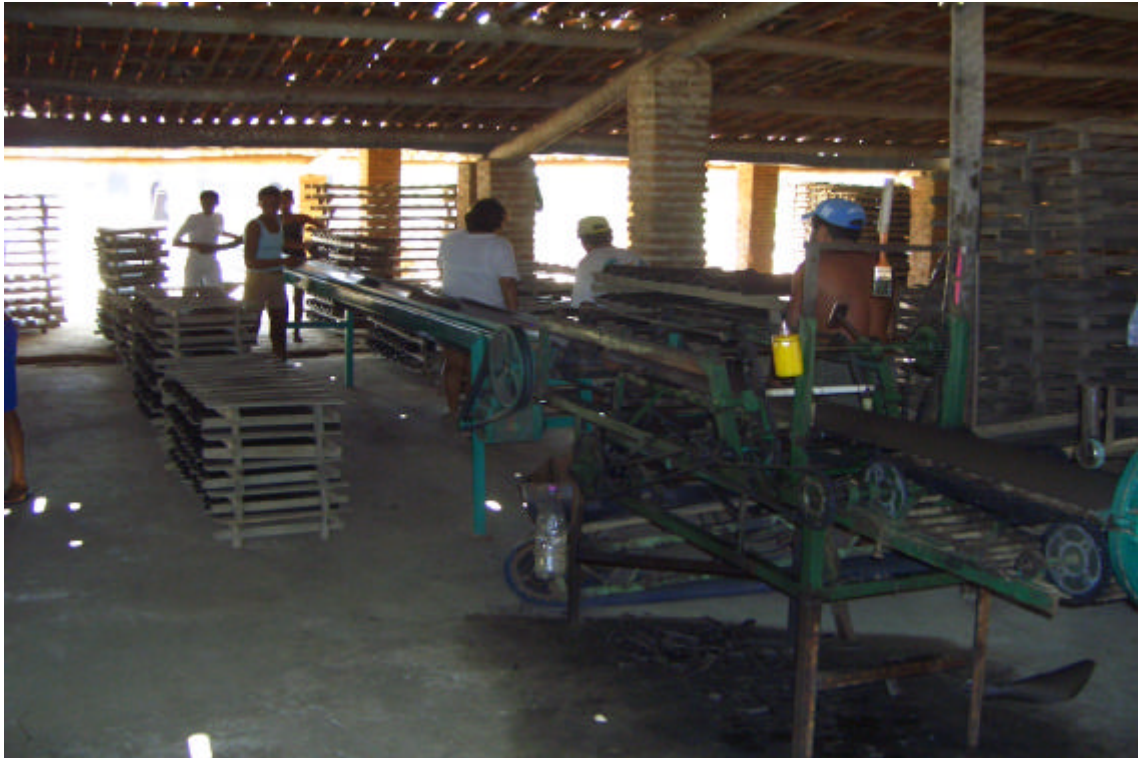
Foto 15. Máquina cortadora e rebarbadora em operação no distrito de Flores, de fabricação local.
