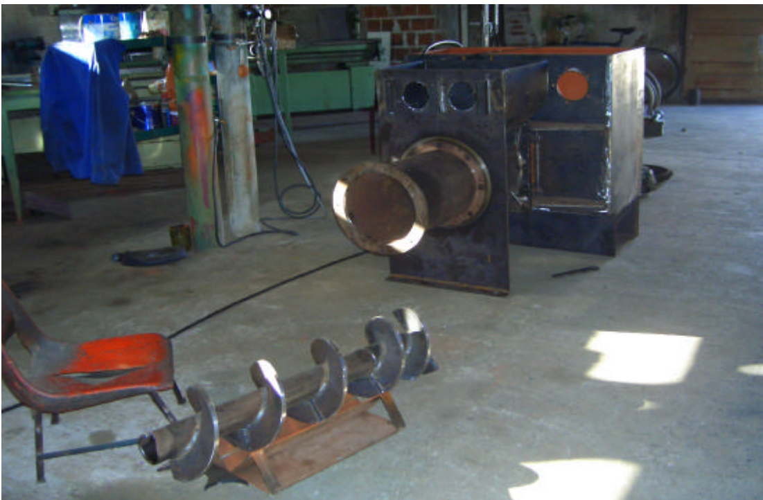
Foto 14. Máquina extrusora em processo de fabricação na Indústria Tabuleirense de Máquinas Ltda. (ITAMAQ).
