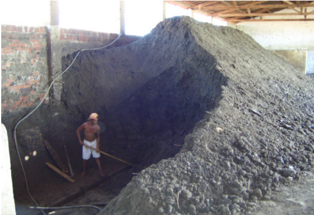
Foto 10. Mistura manual de argilas.
