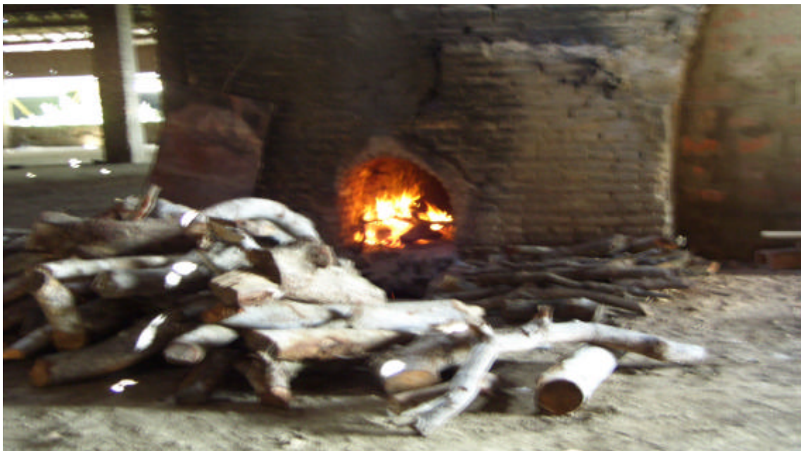
Foto 22. Fornalha de um forno intermitente em indústria cerâmica visitada na microrregião do Baixo Jaguaribe, na qual a área de estudo está inserida.
