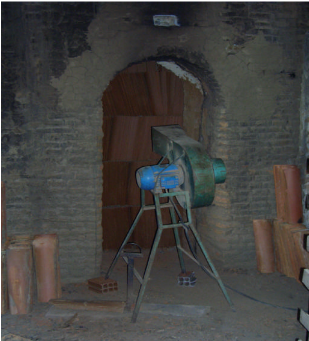
Foto 29. Telhas queimadas em fase de resfriamento por meio do uso de ventilador radial, que em seguida vão ser classificadas.
