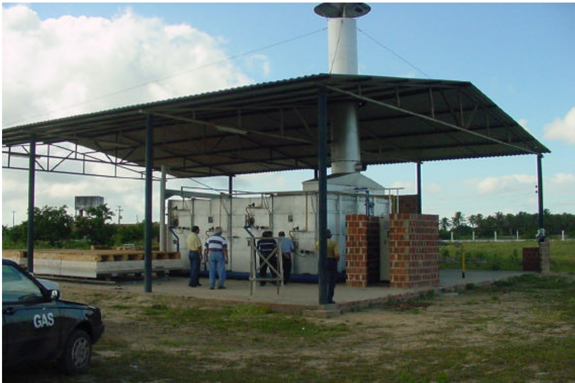
Foto 37. Forno protótipo para cerâmica vermelha em desenvolvimento pelo CTGÁS na região metropolitana de Natal-RN.
