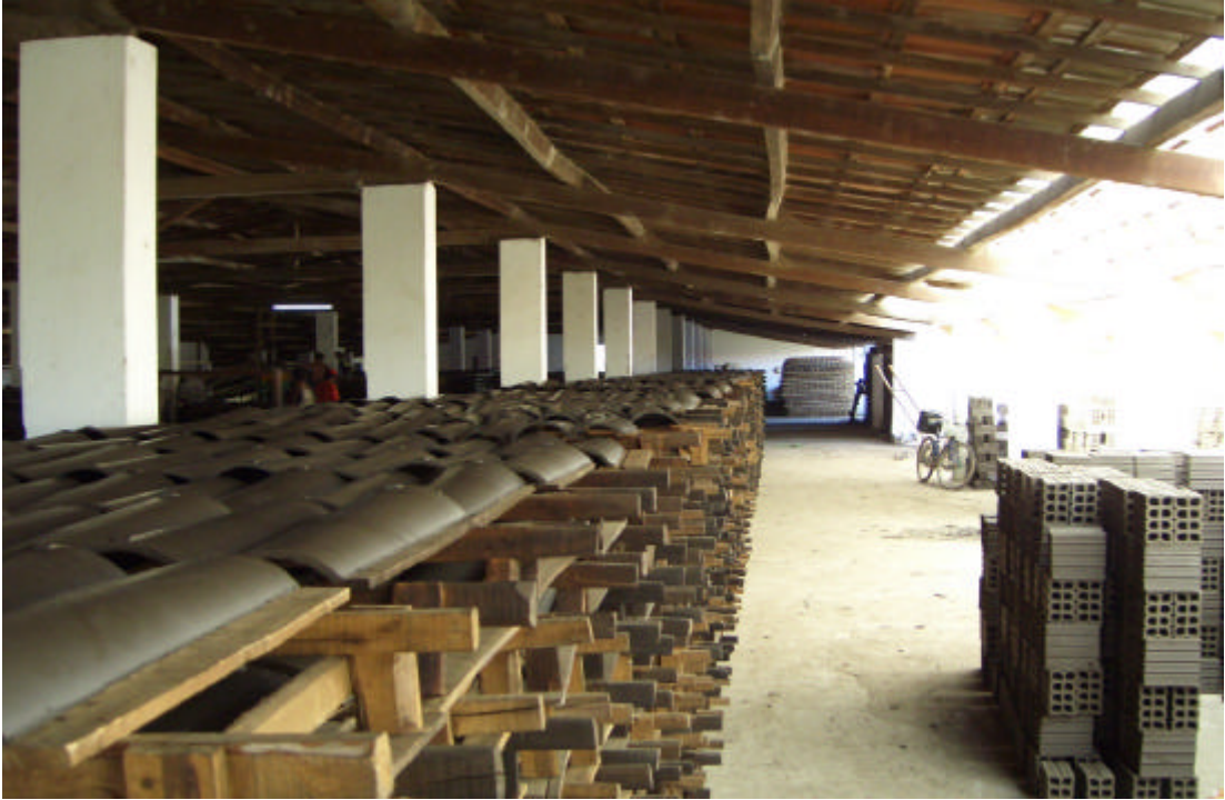
Foto 17. Peças cerâmicas estocadas em grades de madeira, sob galpão, para secagem.
