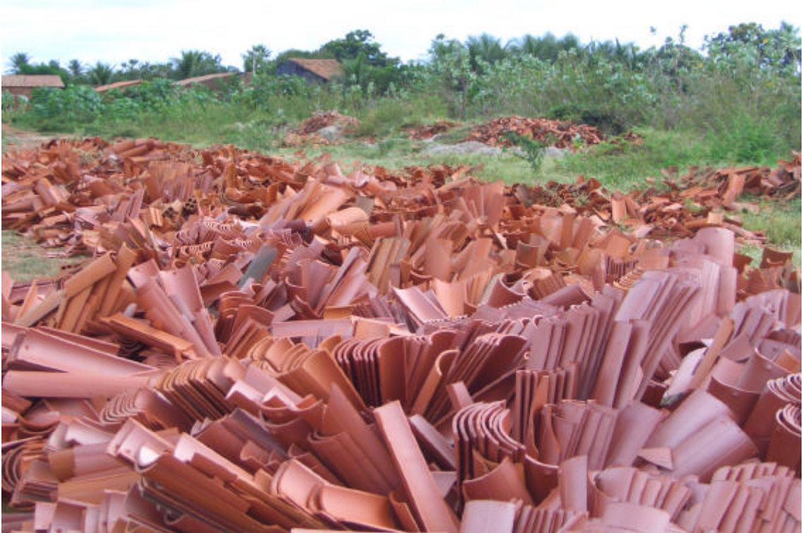
Foto 30. Peças defeituosas e perdas em consequência da falta de caracterização dos materiais argilosos empregados e do proporcionamento correto.
