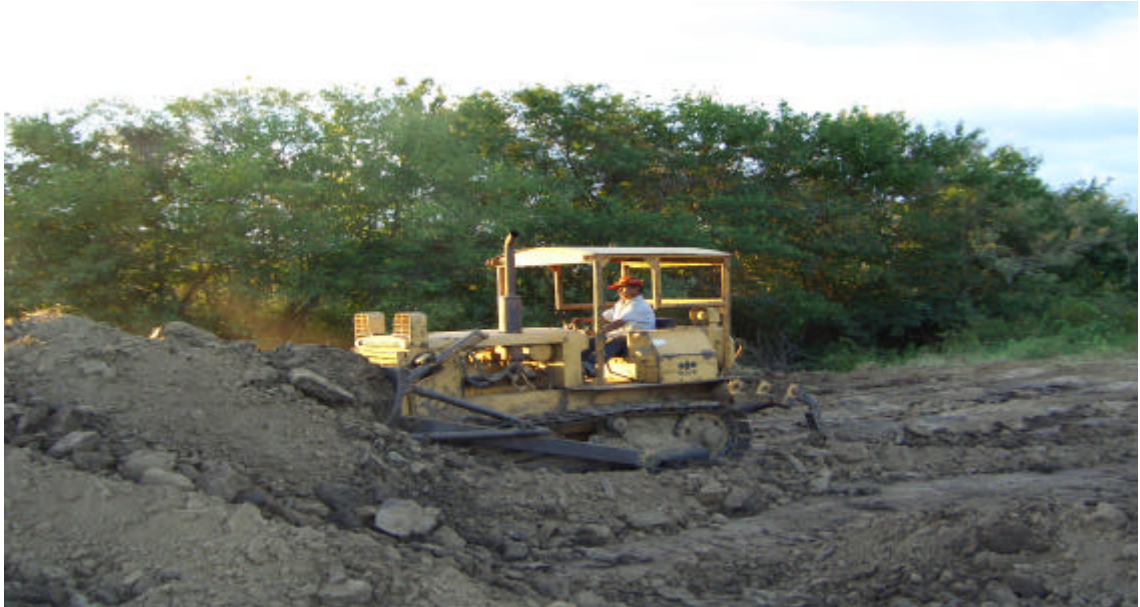
Foto 34. Pequeno trator de esteira empilhando materiais argilosos na região norte do estado do Ceará.
