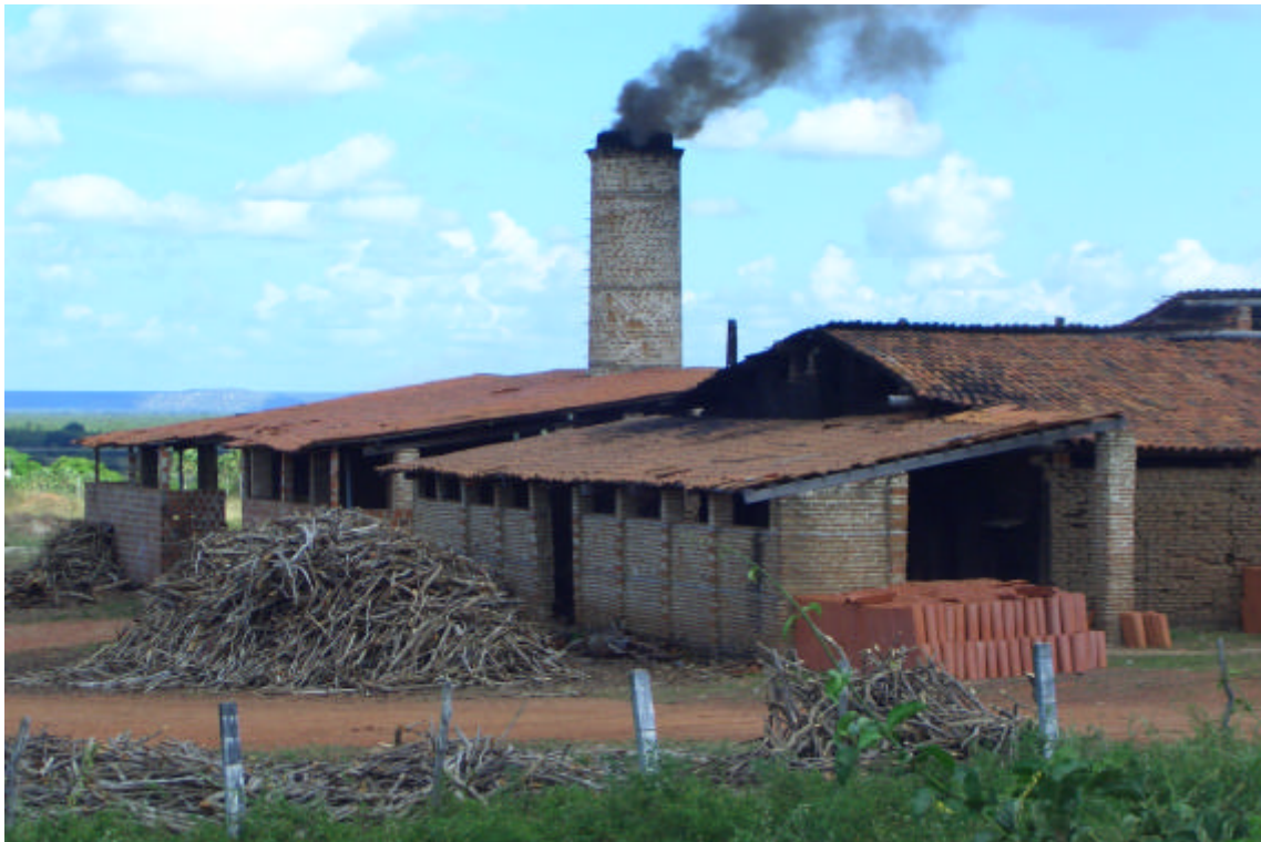
Foto 24. Forno tipo reversível queimando lenha fina em Russas, havendo indicação de corte precoce, com a conseqüente perda de capacidade de suporte do meio ambiente.
