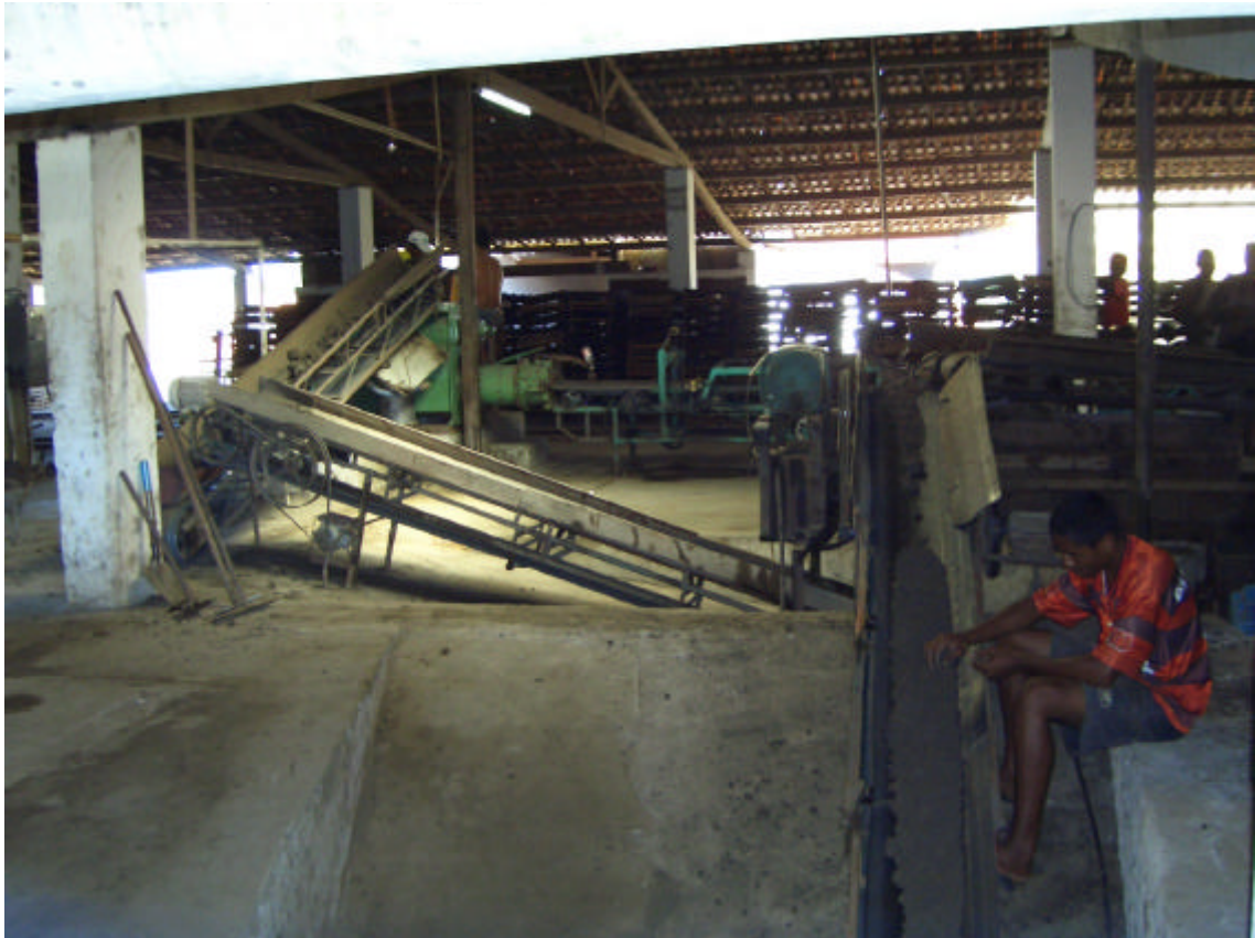
Foto 11. Eliminação visual de pedriscos e raízes.
