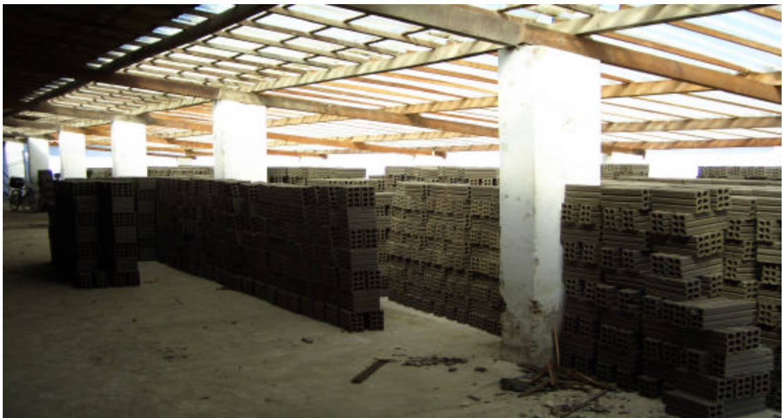
Foto 21. Galpão para secagem de peças, coberto com telhas transparentes, encontrado em uma das cerâmicas visitadas.
