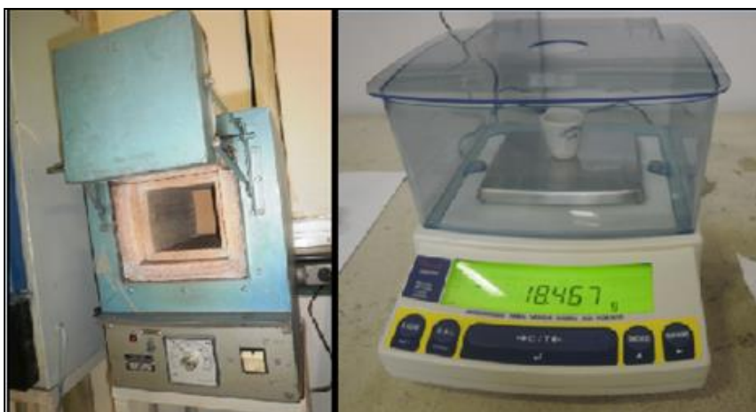
Figura 18 À esquerda forno de mufla para calcinação das amostras em cadinhos de porcelana. À direita, balança de precisão com 3 casas decimais. (Fonte: autor).
