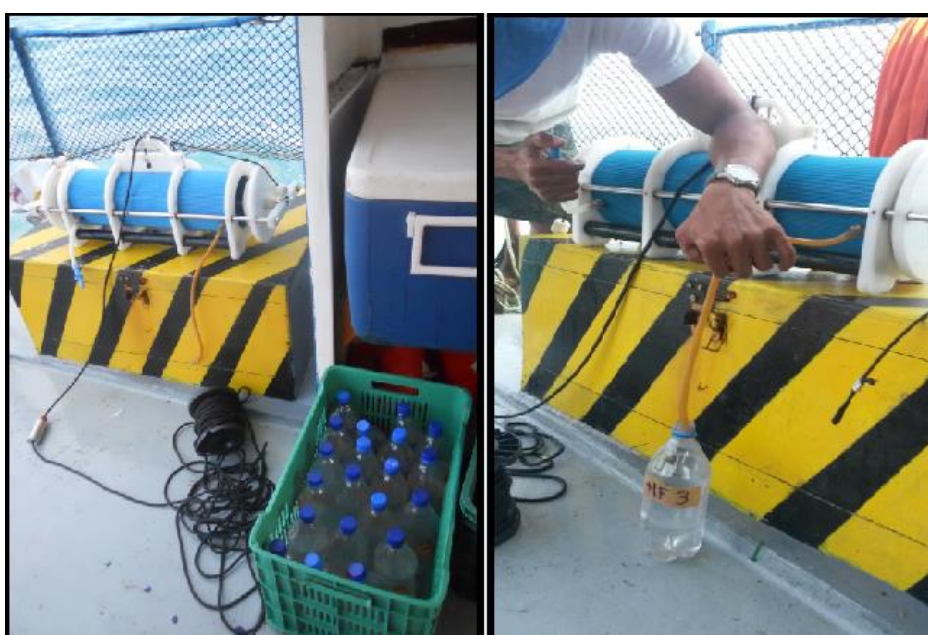
Figura 14 Coleta de amostras de água para análise de material em suspensão na água em superfície e fundo com garrafa de Van Dorn. Fonte: autor
