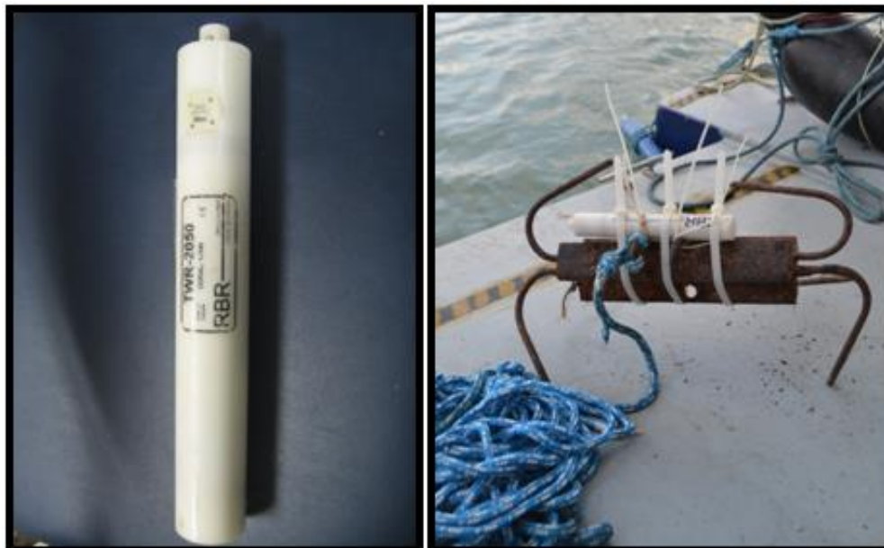
Figura 13 Ondógrafo RBR à esquerda, modelo TWR-2050, e acoplado à garateia à direita para fundeio. (Fonte: autor).
