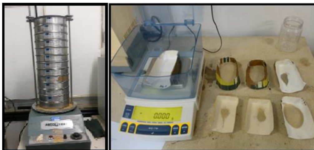
Figura 16 Agitador mecânico “Ro-Tap” à esquerda com sequência de 12 peneiras e à direita, balança de precisão utilizada na pesagem das frações retiradas das peneiras. Fonte: autor.
