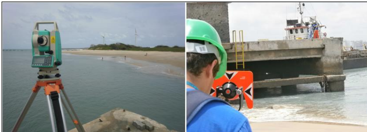
Figura 11 Estação Total posicionada sobre referencial da Portobrás no Porto de Fortaleza com visada para a Praia Mansa onde estão o operador do prisma e os responsáveis pela coleta de amostras. (Fonte: autor).
