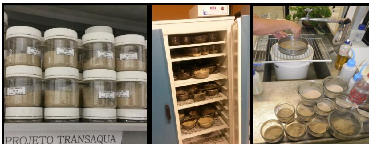
Figura 15 Da esquerda para a direita: amostras no banco de amostras, amostras na estufa a 60°C para secagem e lavagem de amostra para remoção de sais (Fonte: autor).
