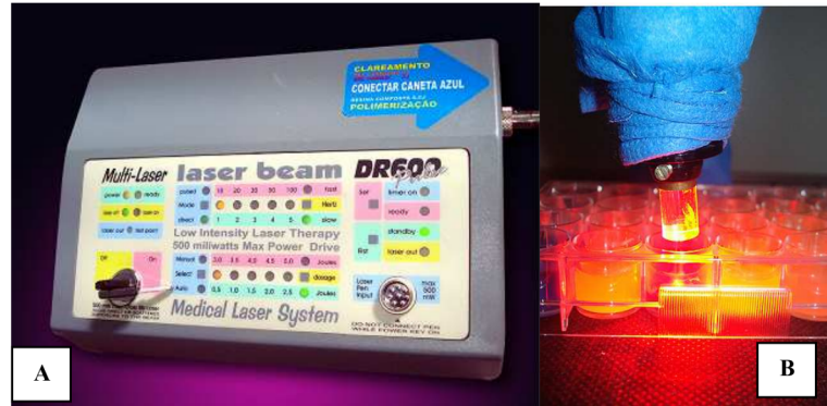
Figura 6– (A) Aparelho de LED Laser Beam com um espectro de emissão de 620 a 660nm e comprimento de onda predominante 638.8 nm. (B) Aplicação do LED sob placas de cultivo.
