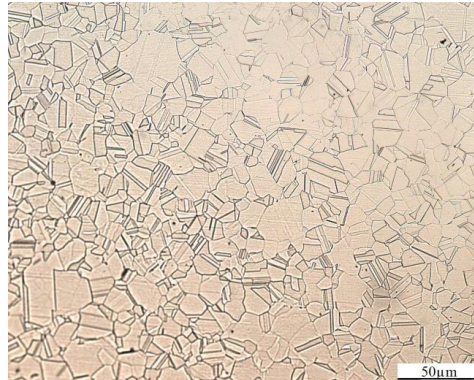
Figura 20 – Imagem obtida por microscópio óptico com aumento de 100X do aço super austenítico após solubilização.
