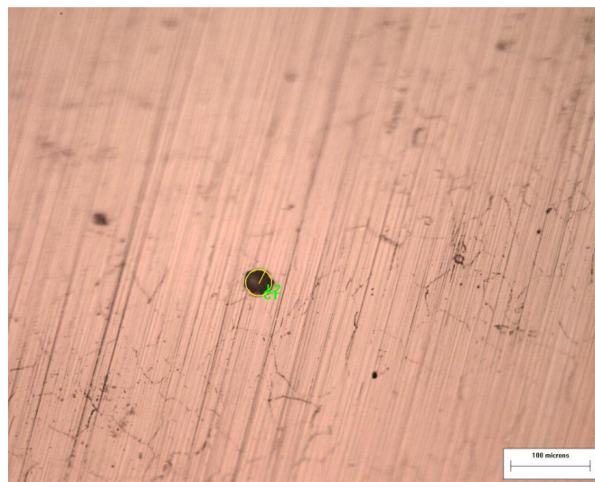
Figura 45 - Pites na superfície do ASA tratado a 700°C durante 72 horas (Microscópio ótico com aumento de 100X).
