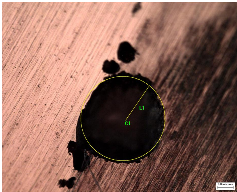
Figura 42 – Frestas na superfície do aço 316L tratado a 700°C (Microscopia ótica com aumento de 100X).
