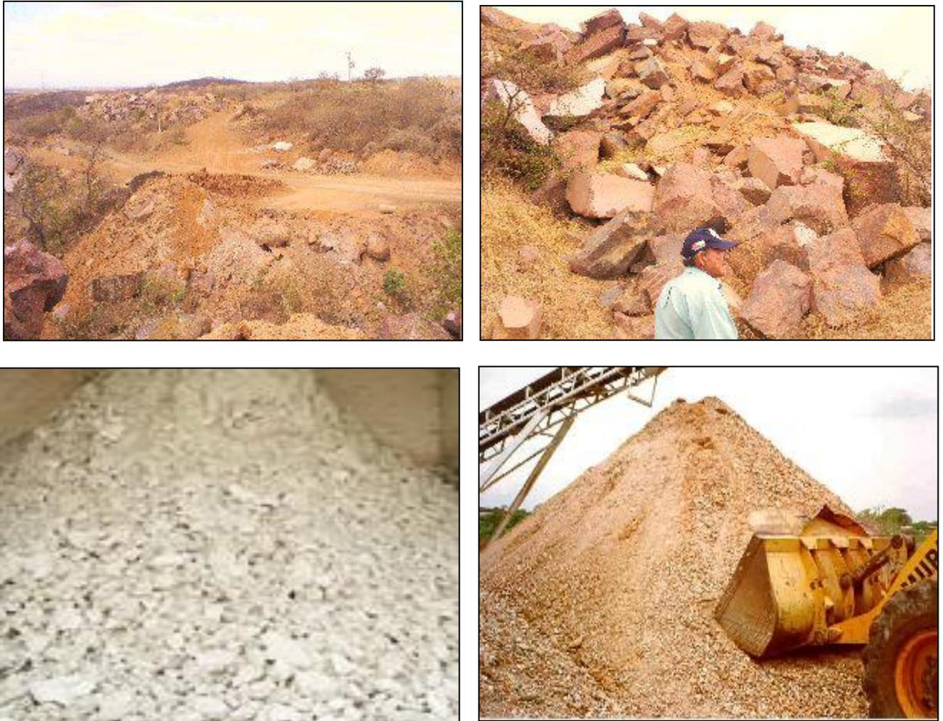
Figura 2.13 - Rejeitos da extração do granito.
