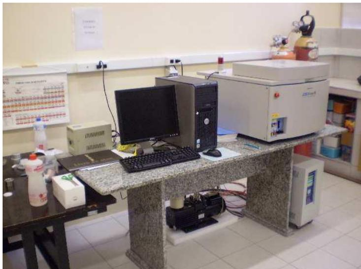
Figura 3.1 – Fluorescência de Raios X / Rigaku (ZSX Mini II)
