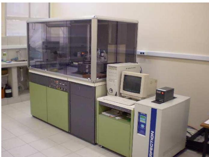
Figura 3.2 – Difratorômetro de Raios X / Rigaku (DMAXB)
