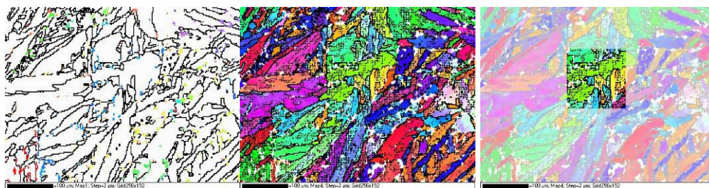
Figura 435 - (a) Mapa de orientação da austenita revertida; (b) mapa de orientações da martensita; (c) grão selecionado para estudo da textura.
