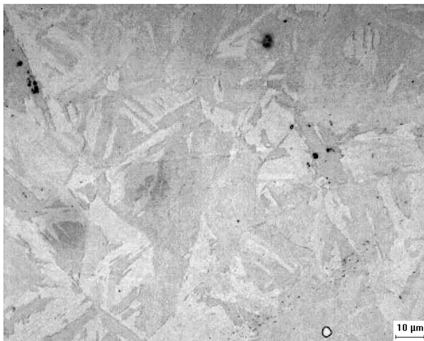
Figura 245 - Micrografia da amostra envelhecida a 600°C e resfriada ao ar.
