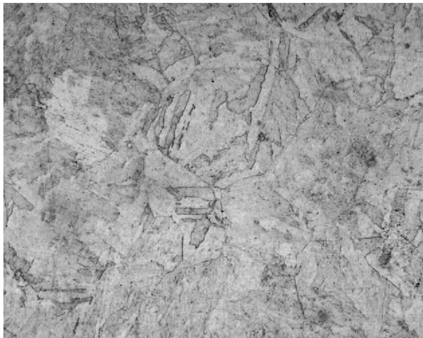
Figura 223 – Micrografia da amostra envelhecida a 600°C e resfriada em N 2 . Aumento: 1000X. Ataque: Picral Modificado.
