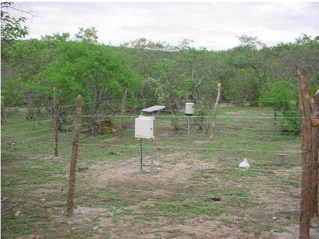
FIGURA 4.12 – Estação Pluviométrica 3 com pluviômetro de bscula (resoluo de 0,254 mm) e sensor de umidade de solo conectados a um mdulo de memria. Medidas automticas da chuva acumulada (a cada 5 min e 6 h) e umidade de solo (a cada 1 h). Data: 02-02-2003.
