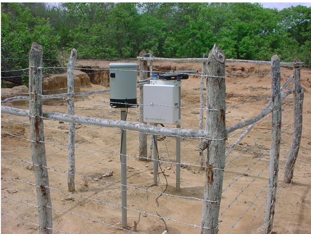
FIGURA 4.10 – Estação Pluviométrica 1 com pluviômetro de báscula (resolução de 0,254 mm) e sensor de umidade de solo conectados a um módulo de memória. Medidas automáticas da chuva acumulada (a cada 5 min e 6 h) e umidade de solo (a cada 1 h). Data: 02-02-2003.
