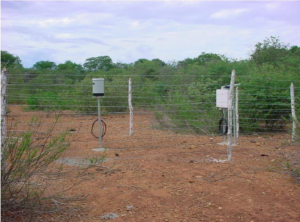
FIGURA 4.11 – Estação Pluviométrica 2 com pluviômetro de bscula (resoluo de 0,254 mm) e sensor de umidade de solo conectados a um mdulo de memria. Medidas automticas da chuva acumulada (a cada 5 min e 6 h) e umidade de solo (a cada 1 h). Data: 02-02-2003.
