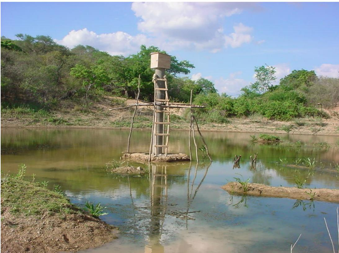
FIGURA 4.5 – Torre tranquilizadora das águas no ponto mais profundo do açude Boqueirão, em que o limnógrafo de bóia foi instalado. Data: 11-01-2003.
