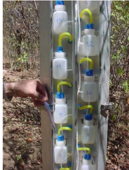
(A) Torre de coleta automática de sedimentos no ramo ascendente do hidrograma instalada, inicialmente, a jusante da calha Parshall. (B) Garrafas de 250 ml dispostas a 7 cm, no total de dezesseis (16).
