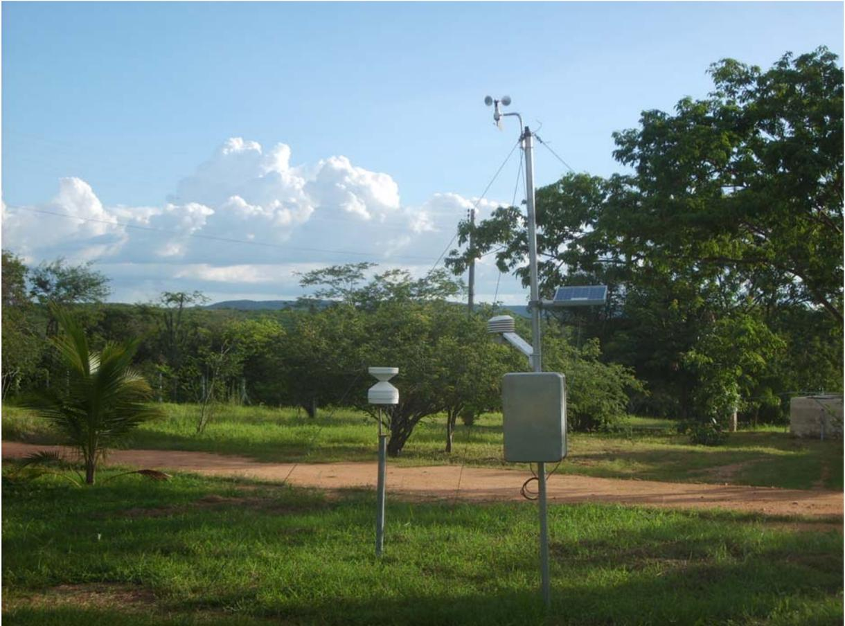
FIGURA 4.8 – Estação Climatológica 1 instalada na Sede da ESEC de Aiuaba, com medidas automáticas a cada hora de: precipitação, temperatura e umidade relativa do ar, velocidade e direção do vento e da sua rajada máxima, radiação incidente e pressão atmosférica. Data: 27-03-2007. Foto do autor.
