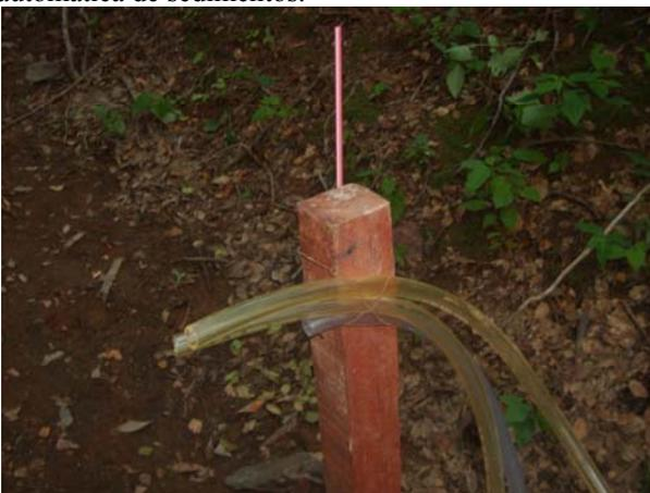
(C) Detalhes dos respiradores presos na estrutura de madeira com arame.
