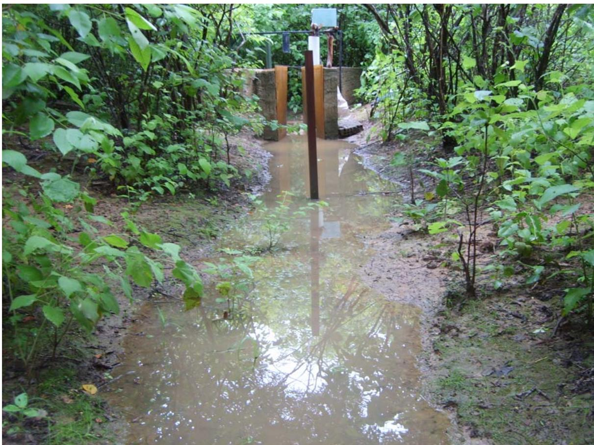
FIGURA 4.18 – Régua limnimétrica instalada imediatamente a jusante da calha Parshall, para realização de curva-chave, no intuito de não se perder dados de vazões máximas acima da capacidade de medição da calha Parshall. Data: 23-03-2007. Foto do autor.
