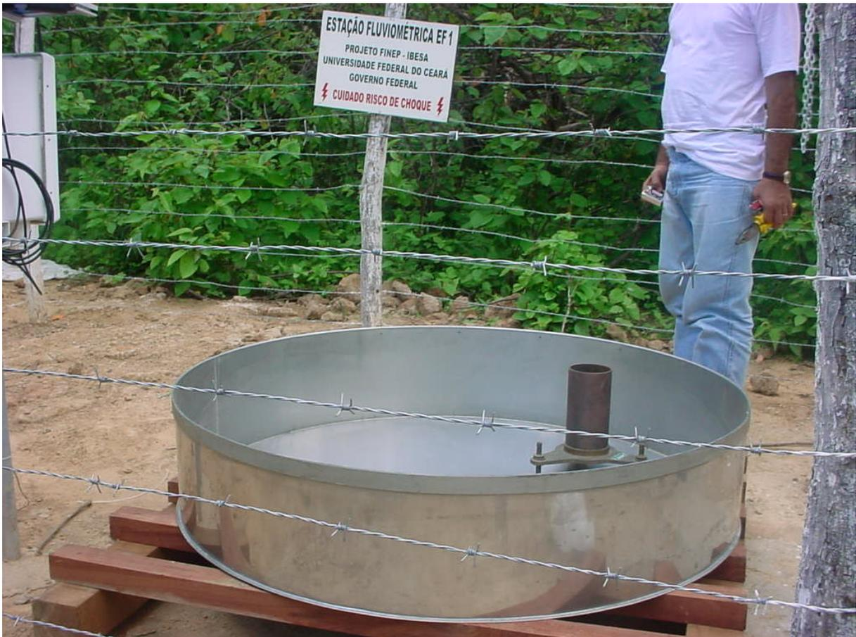
FIGURA 4.9 – Tanque Evaporimétrico Classe A instalado na Estação Pluviométrica 1 com medidas realizadas diariamente por meio de micrometro e de tanque tranquilizador. Data: 19-02-2003, fonte: Araújo, J. et al., 2004a.
