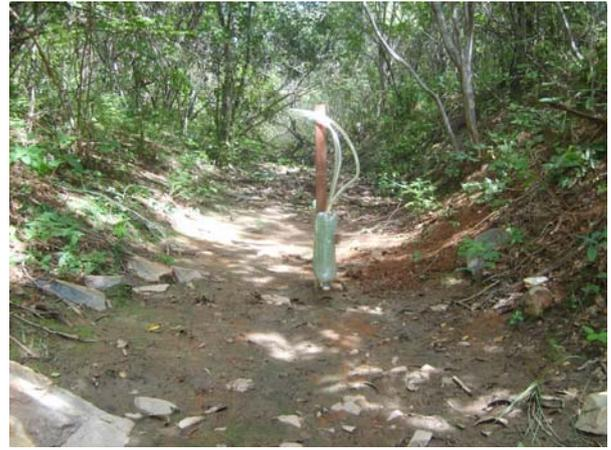
(B) Torre de coleta de sedimentos instalada no leito do riacho principal, sendo a Figura no sentido do fluxo.
