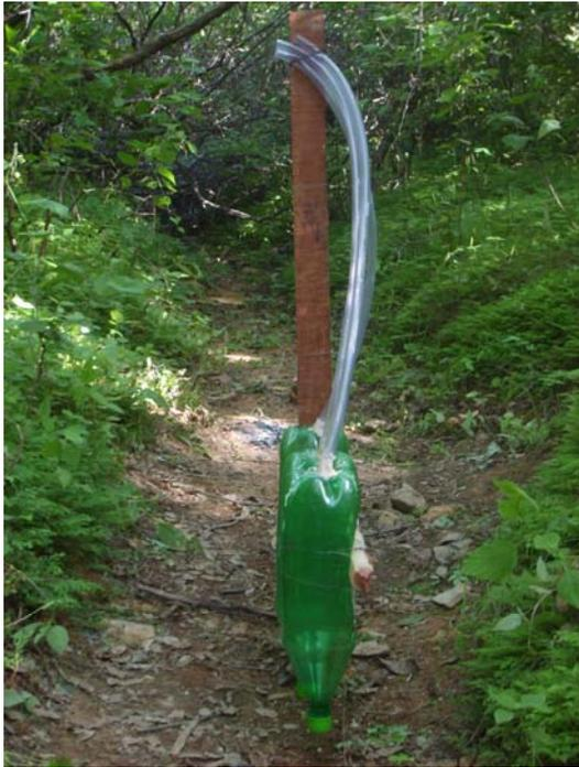
(A) Torre de coleta de sedimentos instalada no leito do segundo maior riacho da BEA, sendo a Figura no sentido do fluxo.
