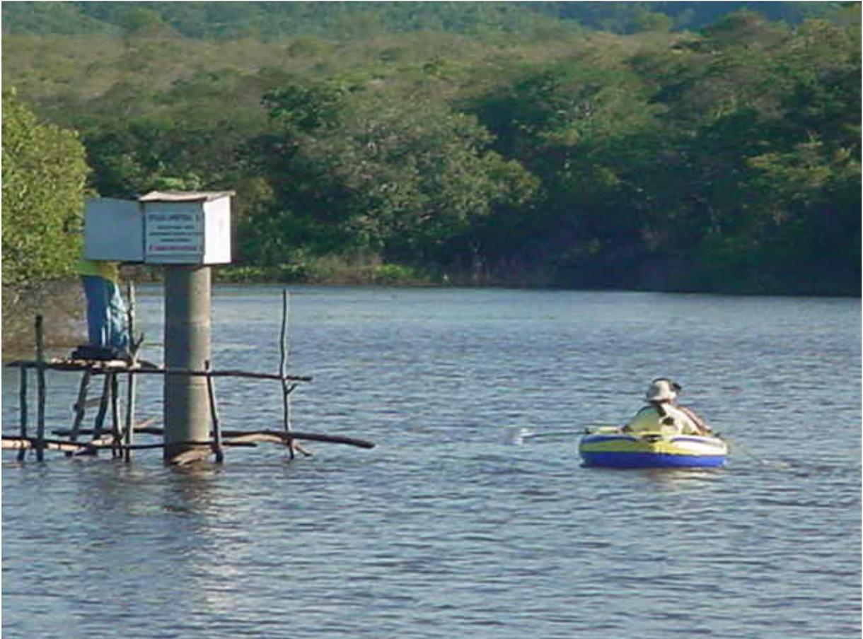
FIGURA 3.3 – Visão geral do açude Boqueirão, exutório da BEA, no momento de coleta de dados de nível d'água do limnógrafo de bóia na torre tranqüilizadora das águas. Data: 29-03-2004.
