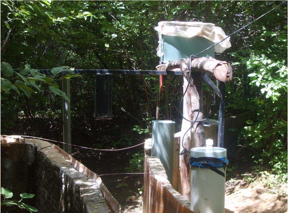
FIGURA 4.19 – Medidor automático de nível d'água no ponto  $H_B$  da calha Parshall, que possui como princípio de medição a variação da pressão da coluna de ar de uma mangueira colocada no ponto  $H_B$ , provocada pela alteração do nível d'água nesse ponto. Data: 20-05-2007. Foto do autor.
