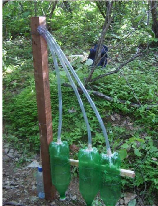
(B) Vista lateral com detalhes das garrafas presas à estrutura de madeira, como aos respiradores.
