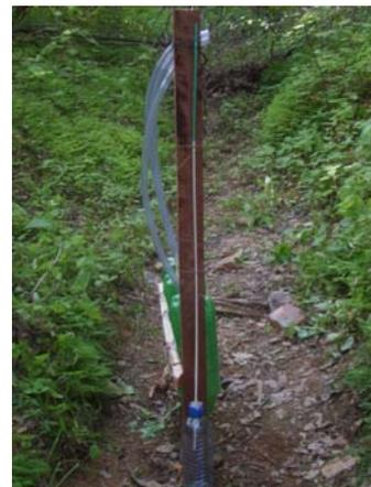
(D) Vista frontal com detalhe da primeira garrafa com furo a 10 cm da superfície do solo, sendo a Figura no sentido contra-fluxo.
