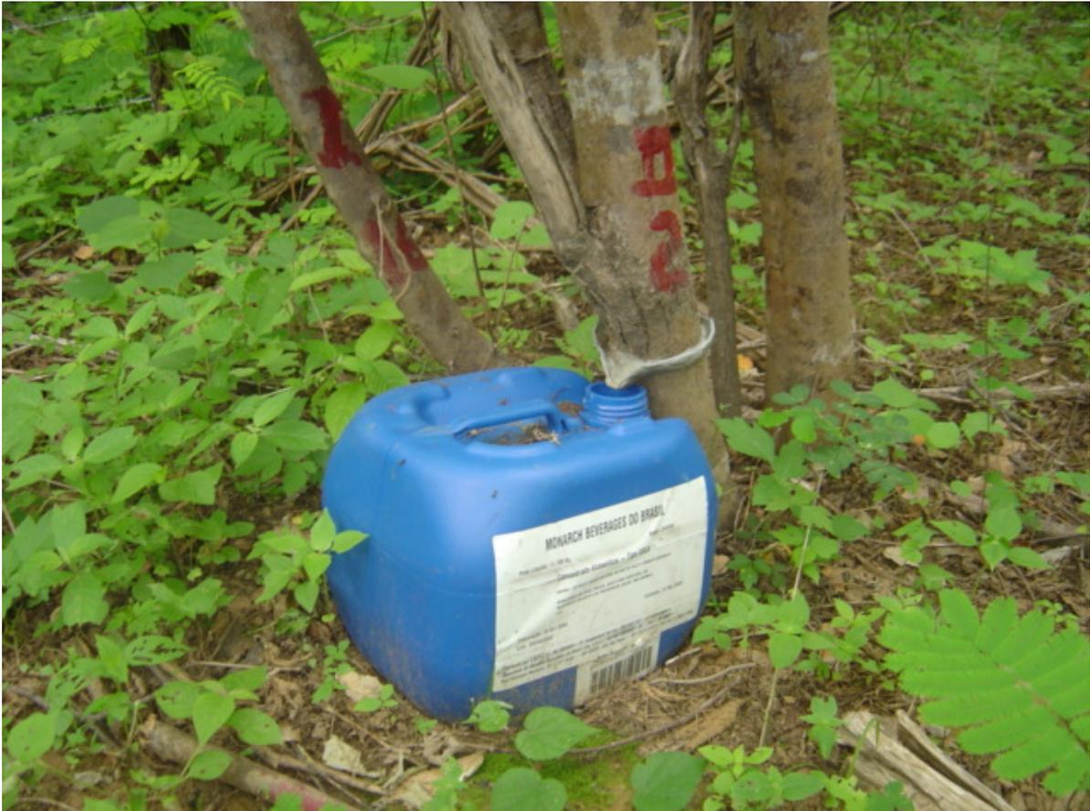
FIGURA 4.14 – Exemplo de calha com pequeno reservatório conectado ao tronco de árvore. Data: 09-03-2004, fonte: Medeiros, 2005.
