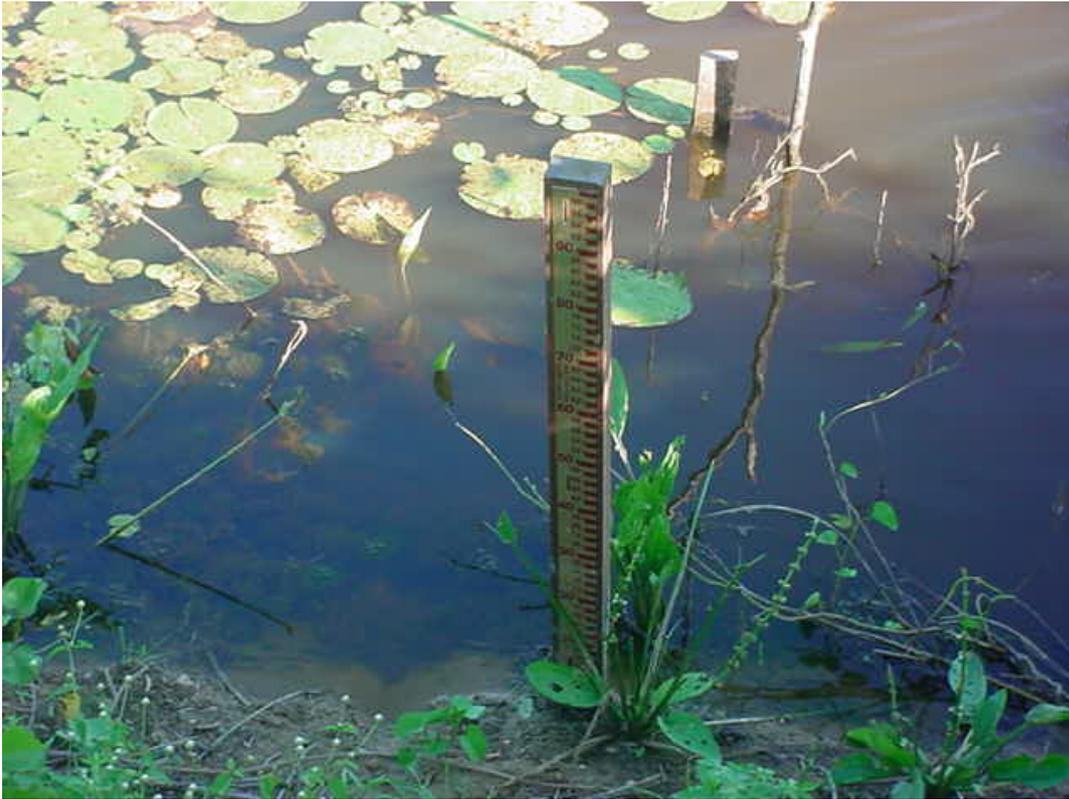
FIGURA 4.4 – Réguas limnimétricas instaladas no açude Boqueirão, a partir de 1,60 m da cota mínima do açude, dispostas a cada metro em um total de quatro réguas. Data: 29-05-2004
