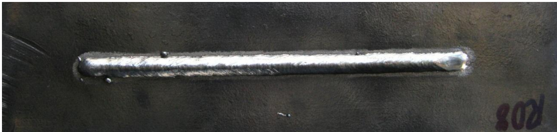
Figura 46 - Aspecto superficial do cordão de solda com U_r=24 V, T.T=Empurrando, Tecimento=ST e V_s=0,4 m/min (Ensaio R8).
