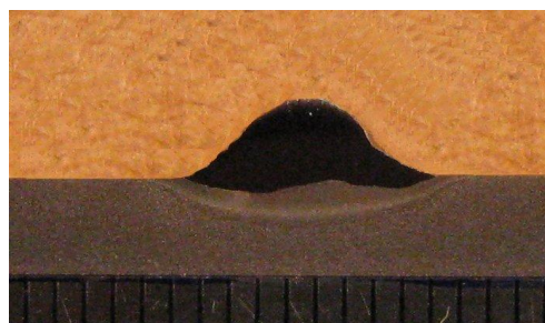
Figura 56 - Seção transversal do cordão de solda com Liga=C-276, Gás=100% Ar, V_s=0,4 m/min e U_r=22 V (Ensaio R16).
