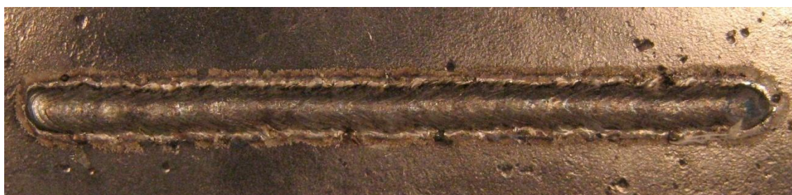
Figura 55- Aspecto superficial do cordão de solda com Liga=C-276, Gás=100% Ar, V_s=0,4 m/min e U_r=22 V (Ensaio R16).
