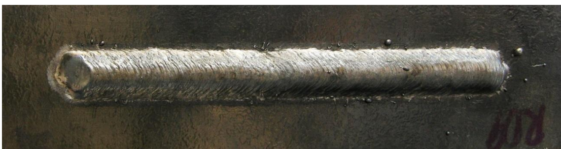
Figura 48 - Aspecto superficial do cordão de solda com U_r=24 V, T.T=Puxando, Tecimento=TT e V_s=0,2 m/min (Ensaio R9).
