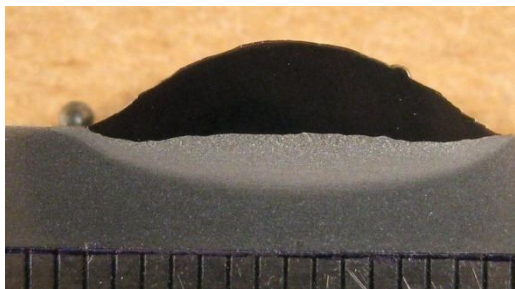
Figura 49 - Seção transversal do cordão de solda com U_r=24 V, T.T=Puxando, Tecimento=TT e V_s=0,2 m/min (Ensaio R9).
