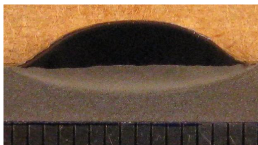
Figura 54 - Seção transversal do cordão de solda com Liga=625, Gás=100% Ar, V_s=0,2 m/min e U_r=20 V (Ensaio R10).
