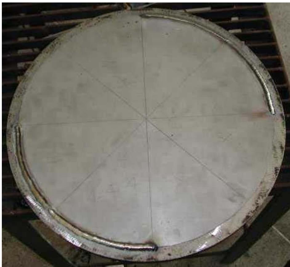
Figura 43. Deposição do cordão de solda no terceiro quadrante dos corpos de prova.
