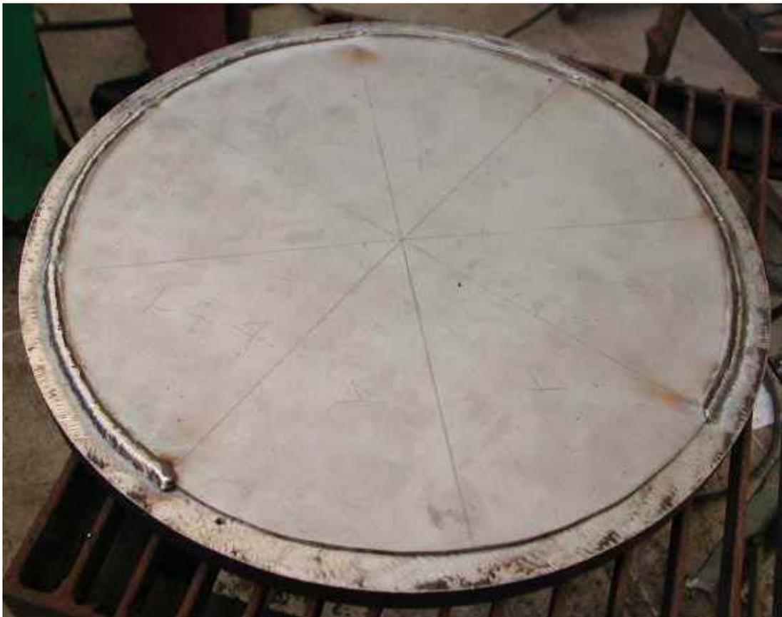
Figura 44. Deposição do cordão de solda no terceiro quadrante dos corpos de prova.
