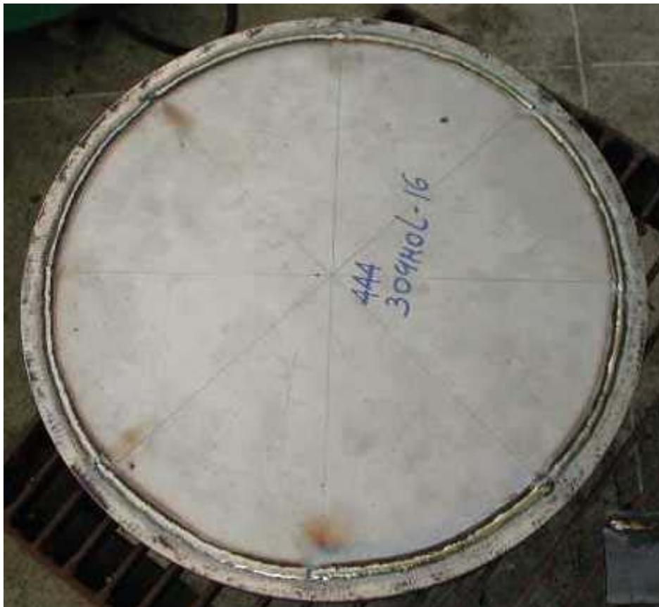
Figura 45. Deposição do cordão de solda no terceiro quadrante dos corpos de prova.
