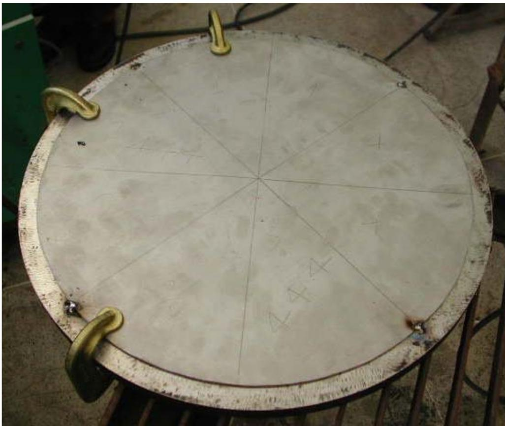
Figura 41. Corpo de prova para a realização das soldagens com o uso de grampos de fixação e aplicação de pontos de solda.
