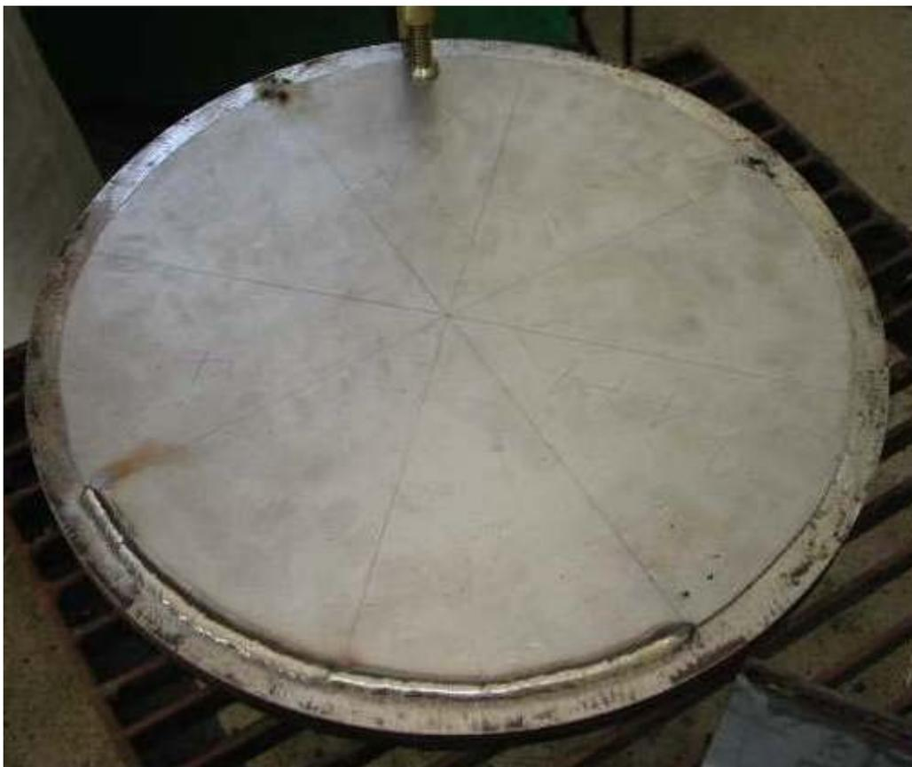
Figura 42. Deposição do cordão de solda no primeiro quadrante dos corpos de prova.
