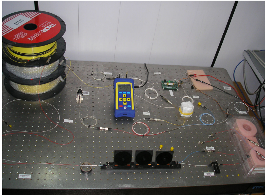
Figura 4.9: Foto da configuração óptica utilizada na implementação do sistema de DQC polarimétrico executando o protocolo B92.
