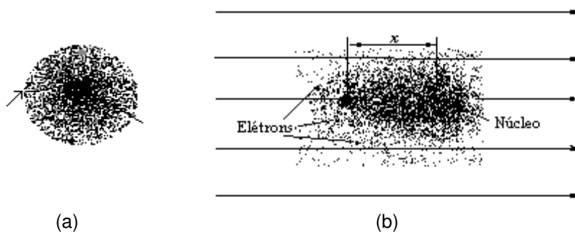
Figura 2.2: (a) Polarização de um átomo sem a aplicação de um campo elétrico externo e (b) com a aplicação de um campo elétrico externo [5]
